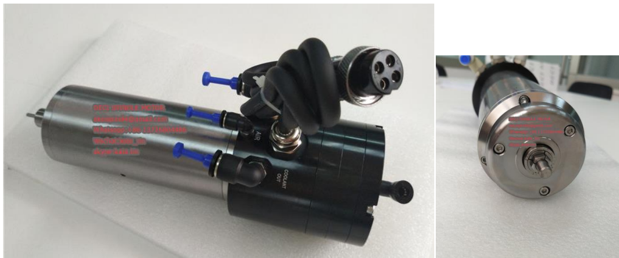
Слика 4.5 Мотор вретено са воденим хлађењем и стезним системом, MORET - Кина [7]
