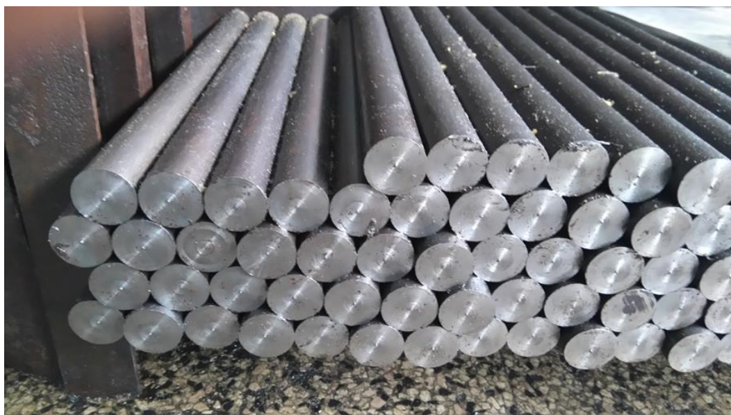
Слика 27. Ваљане шипке које се користе за производњу цеви калибра 7,62 mm
