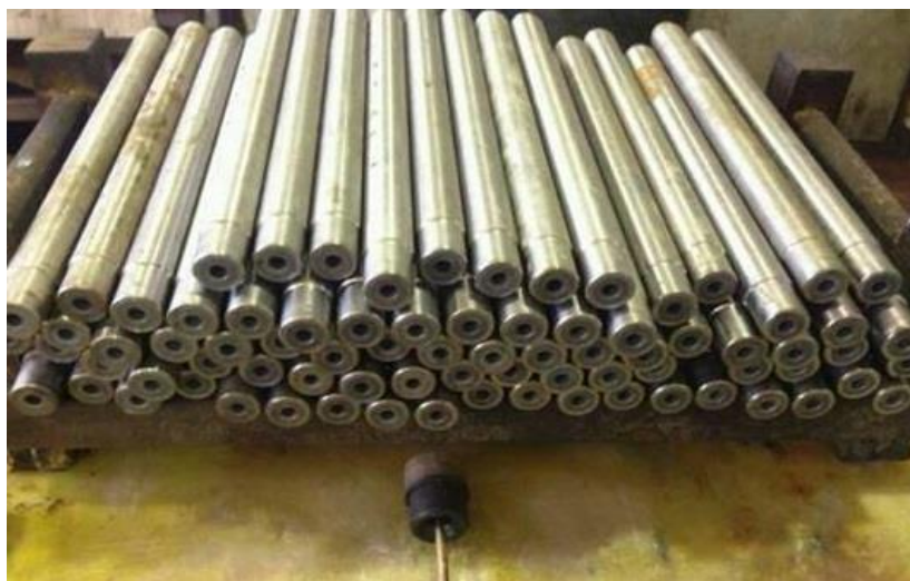
Слика 32. Припремци цеви калибра 7,62 mm спремни за електрохемијску обраду
