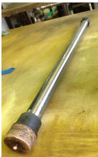
Слика 33. Катода са заптивним елементима убачена у припремак цеви калибра 7,62mm
