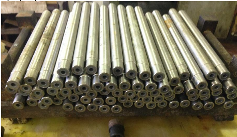
Слика 47. Припремки цеви након операције дубоког бушења
