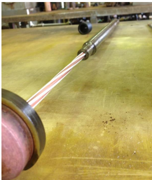
Слика 50. Убацивање катодe за електрохемијско ожљебљење у припремак цеви
