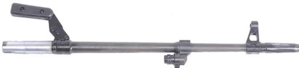
Слика 56. Коначан изглед цеви калибра 7,62 mm митраљеза М84 [8]
