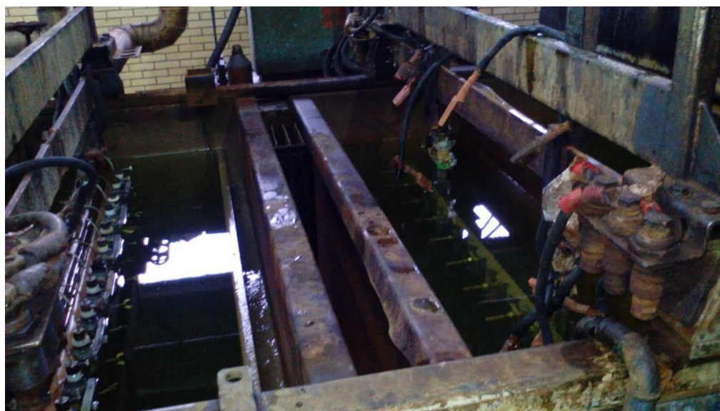
Слика 54. Припремци цеви потопљени у електролит за хромирање [4]
