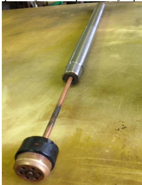
Слика 48. Убацивање катодe за електрохемијско полирање у припремак цеви
