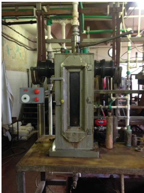
Слика 49. Машина за електрохемијско полирање цеви
