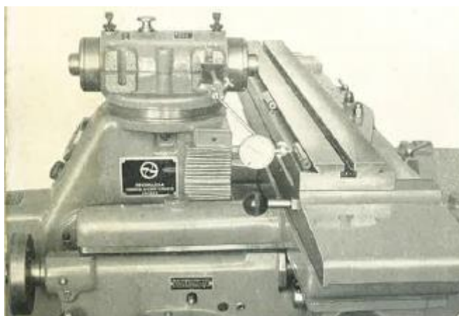
Сл. 113 – Испитивање паралелности вођице на окретном столу са смером кретања уздужног стола
