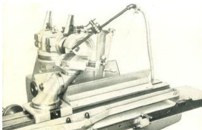
Сл. 123– Брушење стругарског ножа са оштрицом од тврдог метала мокрим начином
