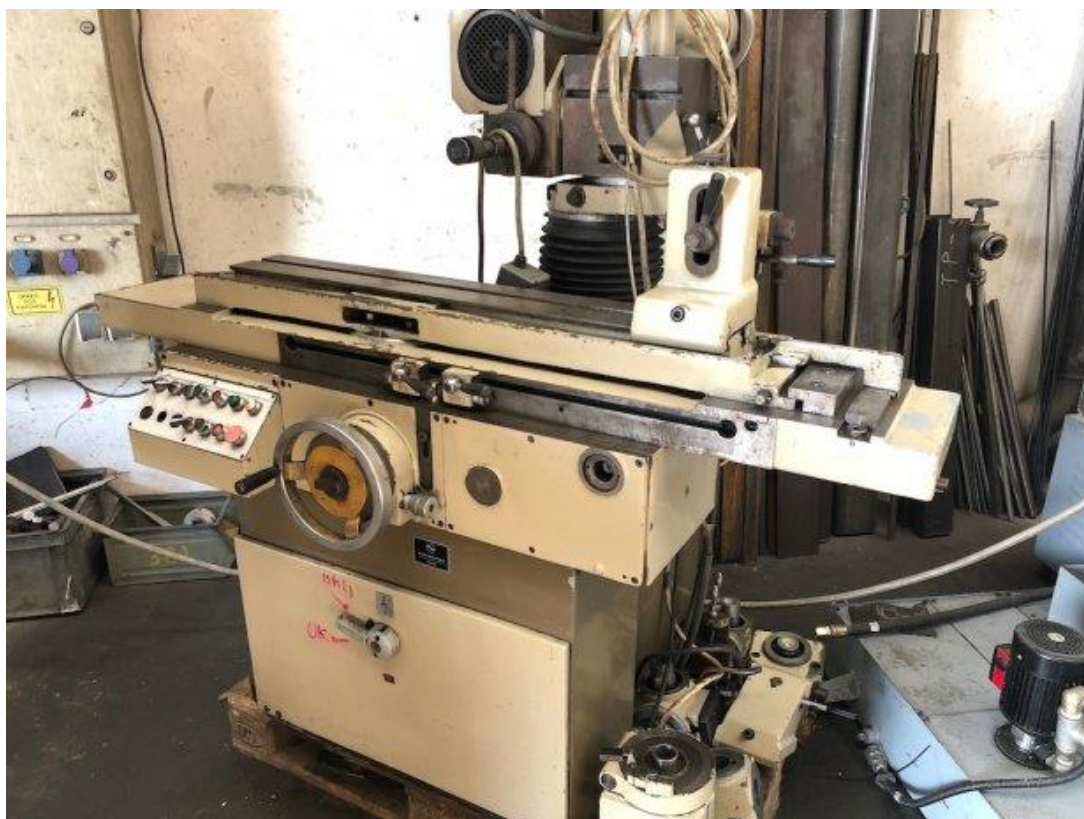
Сл. 4 – Универзална оштрилица са могућношћу померања носача тоцила уздуж вертикалног стуба
