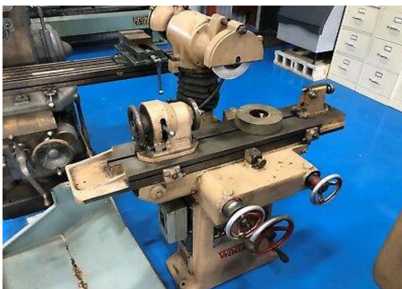
Сл. 2 – Универзална оштрилица резних алата са вертикалним померањем супорта
