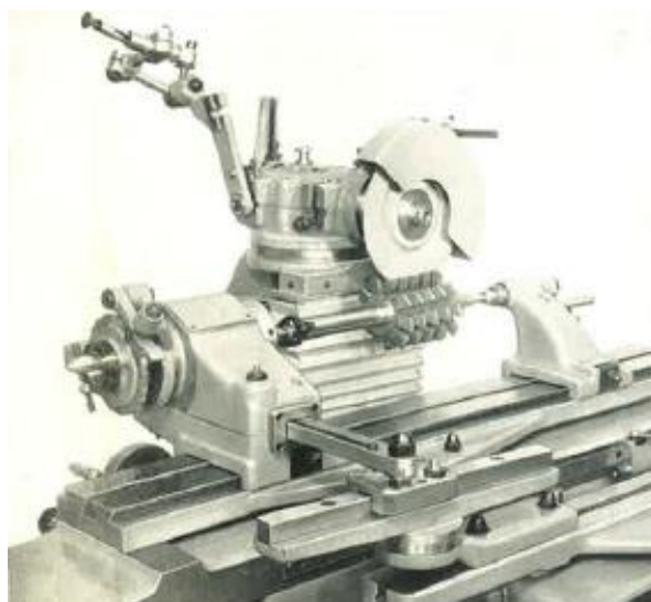
Сл. 98 – Оштрење одвалног глодала за зупцанике. Универзални уређај за профилисање бруса заокренут је из радног положаја
