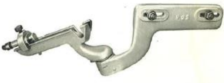
Сл. 39 - Уређај за оштрење спиралних сврдла
