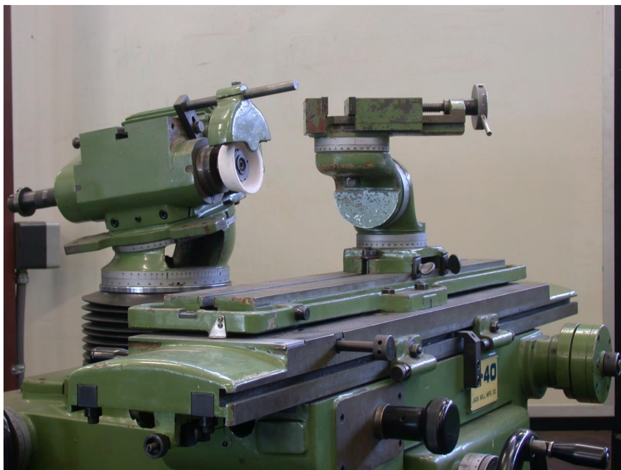
Сл. 3 – Универзална оштрилица са уздужним кретањем супорта
