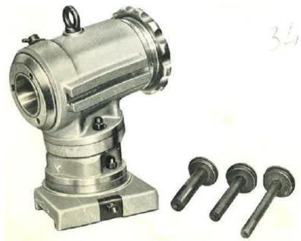
Сл. 33 - Уређај за оштрење тешких резних глава
