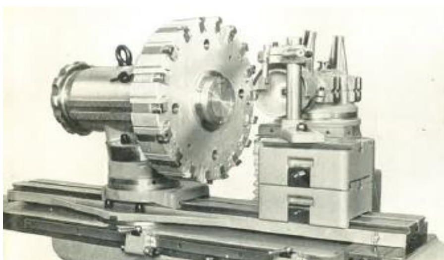
Сл. 83 – Брушење слободних површина на ободним оштрицама тешких резних глава са подупирањем на други начин
