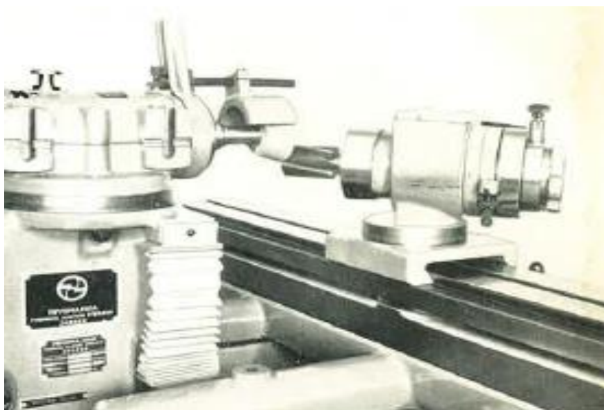
Сл. 87 – Натражно брушење резног дела упуштача
