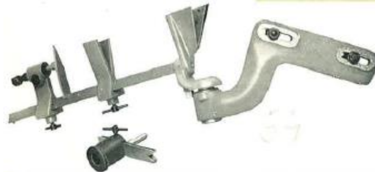
Сл. 40 - Уређај за оштрење спиралних сврдала
