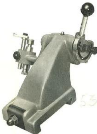
Сл. 42 - Уређај за профилирање облине бруса
