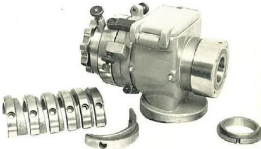
Сл. 36 - Уређај за аксијално и назадно брушење
