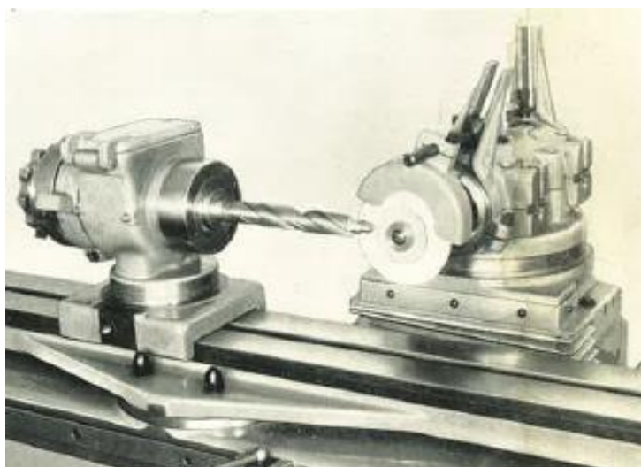
Сл. 90 – Натражно брушење степенастог профилног сврдла у аксијалном, а истовремено и у радијалном смеру
