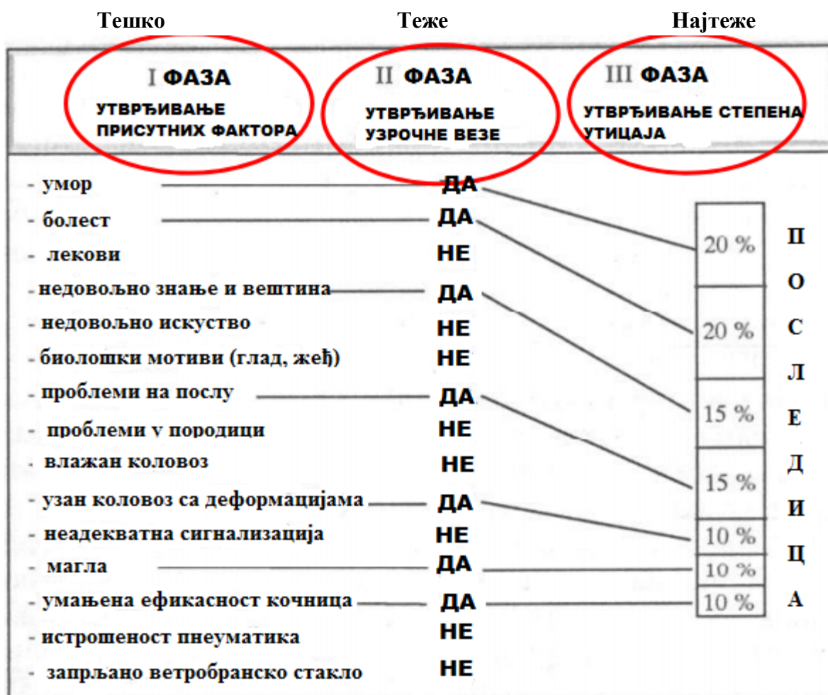
Слика 2 – Упрошћен шематски приказ поступка квантифицирања узрока саобраћајне незгоде [6]
