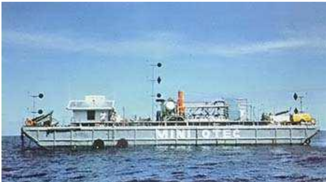
СЛИКА 23. Прво експериментално бродско постројење са затвореним процесом, МИНИ-ОТЕК, на којем је 1979. године извршена прва успешна ОТЕК производња (нето P > 0 ), Кеахоле Поинт, оток Хаваји, САД
