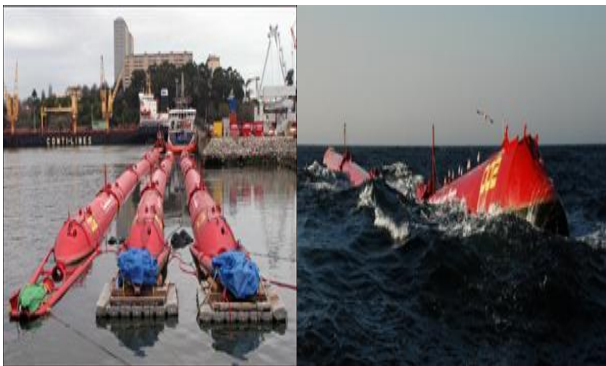
СЛИКА 7. Пеламис машине користе енергију таласа за производњу електричне енергије
