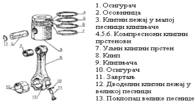
Слика 3. Покретни делови мотора (клипна група + клипњача) [3]
