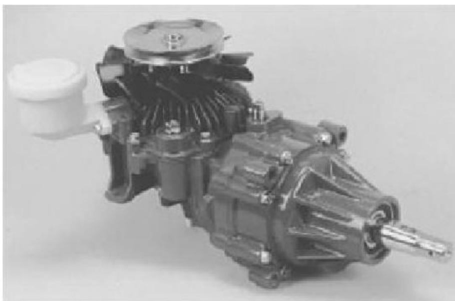
Слика 29. Комбинована хидростатичка трансмисија која спаја регулациону пумпу, регулациони мотор, систем управљања и све остале помоћне компоненте у једно кућиште
