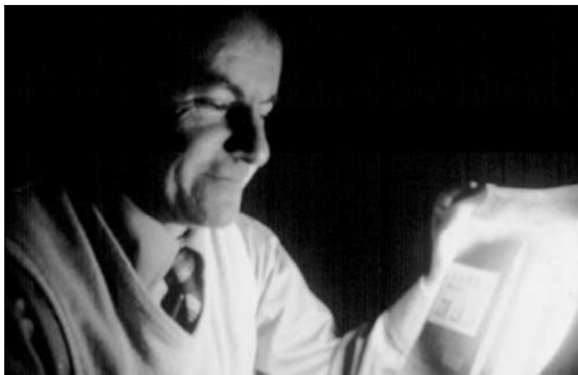
Слика 48 - Интерпретација радиографије са илуминатором високог интензитета
