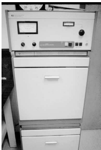
Слика 27 – Рендгенски систем од 150 kV
