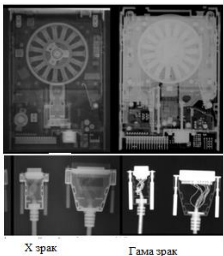
Слика 64 – Упоредивање радиографског снима снимљеног X и гама зрачењем
