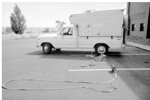
Слика 31– Подешавање експозиција гама зрака
