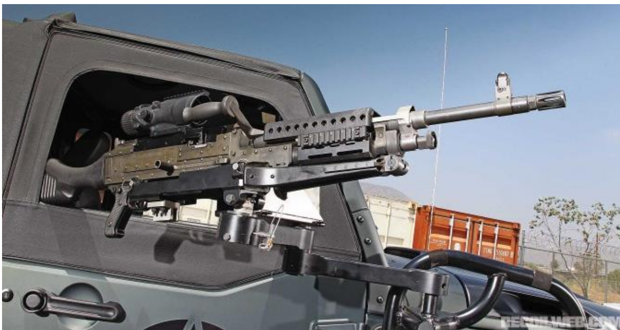
Слика 2.6: Оружје монтирано на возило помоћу „swing arm“ механизма [16]
