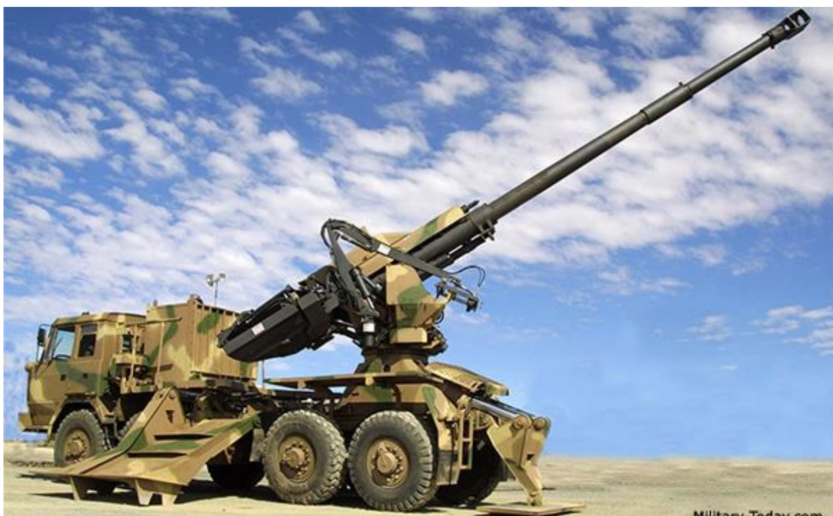
Слика 2.3: Самоходна топ-хаубица 155 mm T5-52 [13]
