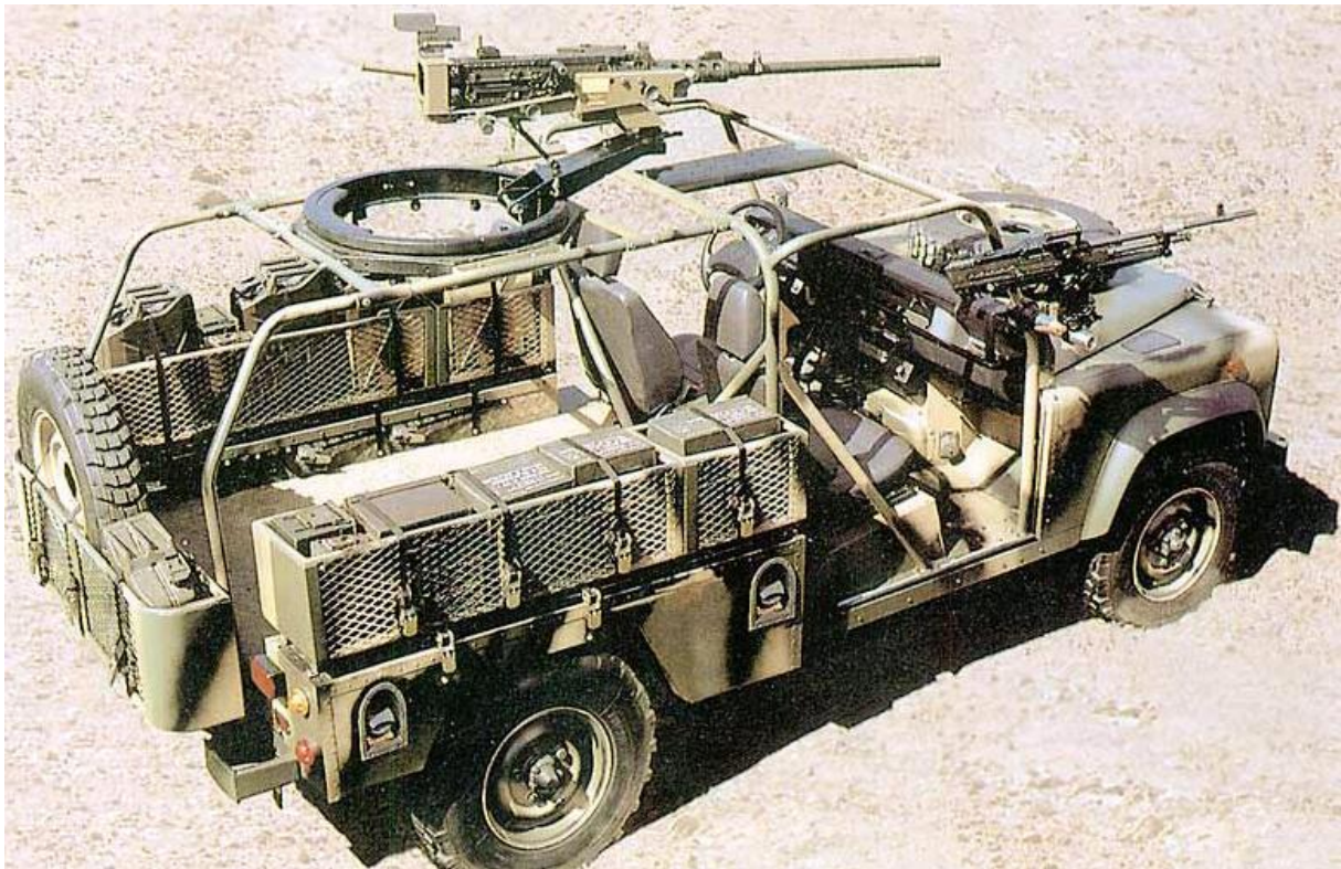
Слика 2.7: Land Rover Defender модификован за војну употребу, са митраљезом монтираним помоћу туреле и пушком помоћу „swing arm“ механизма [17]
