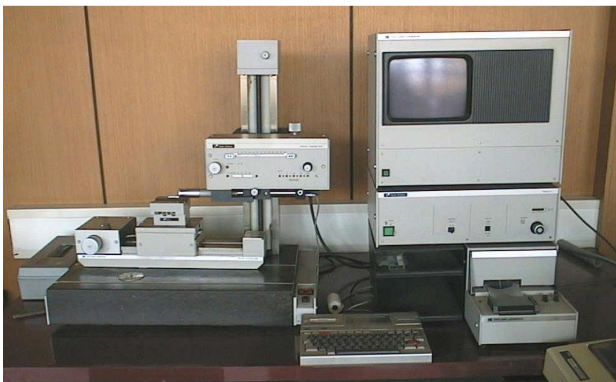
Слика 5.3 Уређај за мерење храпавости Talysurf-6, на Факултету инжењерских наука у Крагујевцу
