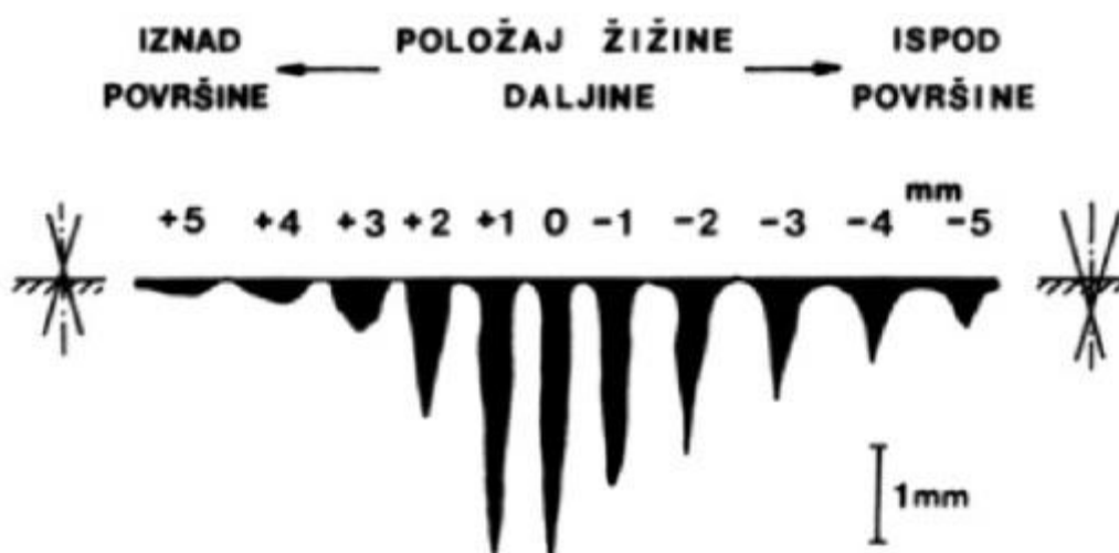
Слика 2.21 Утицај положаја фокуса на облик и дубину рупе [1]
