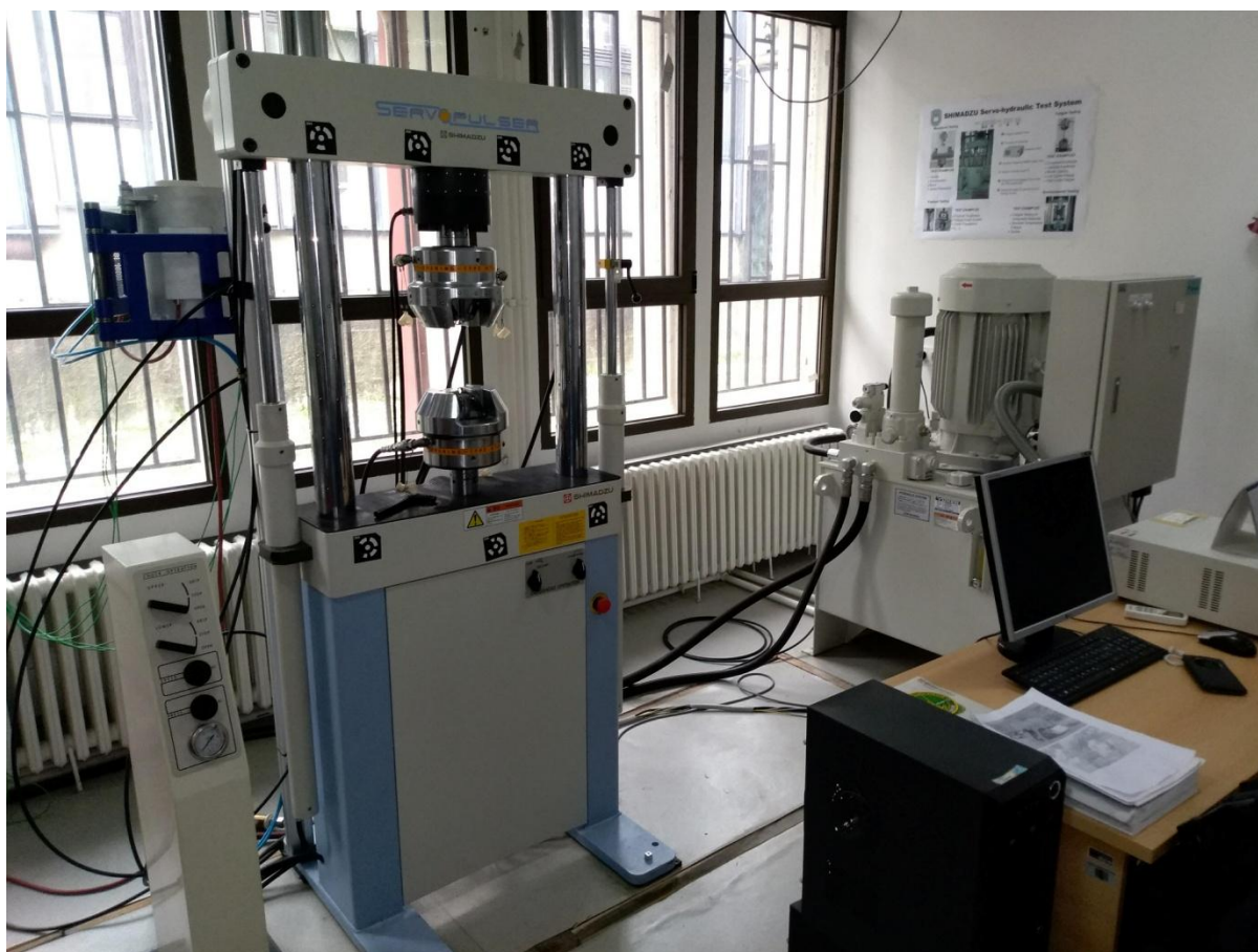
Слика 5.17 Кидалица SHIMADZU Servopulser EHF-EV101K3-070-0A на Факултету инжењерских наука
