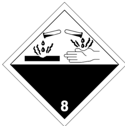
Слика 4 - Ознака опасности (класе 8): Символ (течности које се просипају из две епрувете и нагризају шаку и метал): црн; Основа: горња половина беле боје; доња половина црне боје са оквиром беле боје; Број „8“ у доњем углу.
