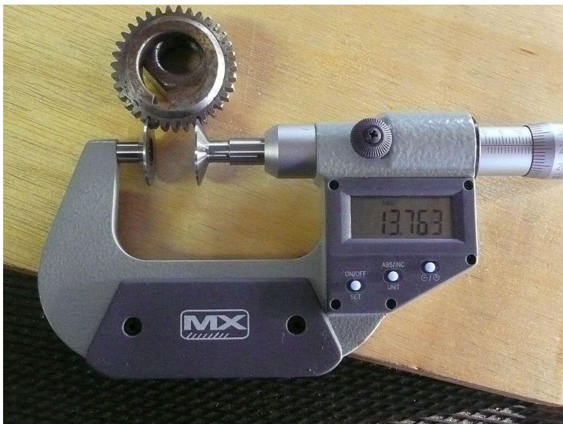
Слика 2.6 Микрометар за мерење тачности зупчаника [10]
