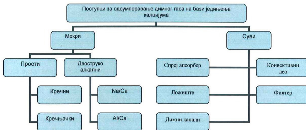
Слика 6. - Графички приказ поделе поступка за одсумпоровања димних гасова према критеријуму агрегатног стања производа реакције одсумпоровања [4]
