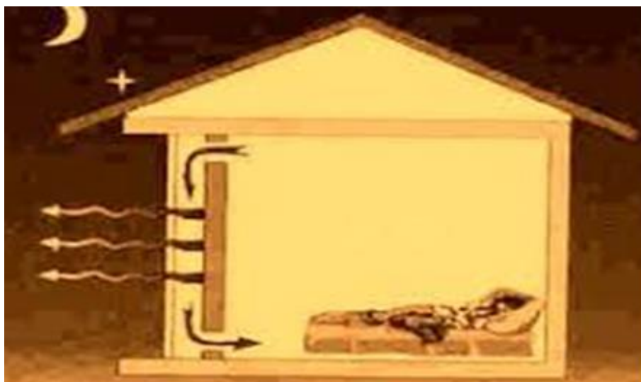
Слика 28. Хлађење Тромбовог зида [14]
