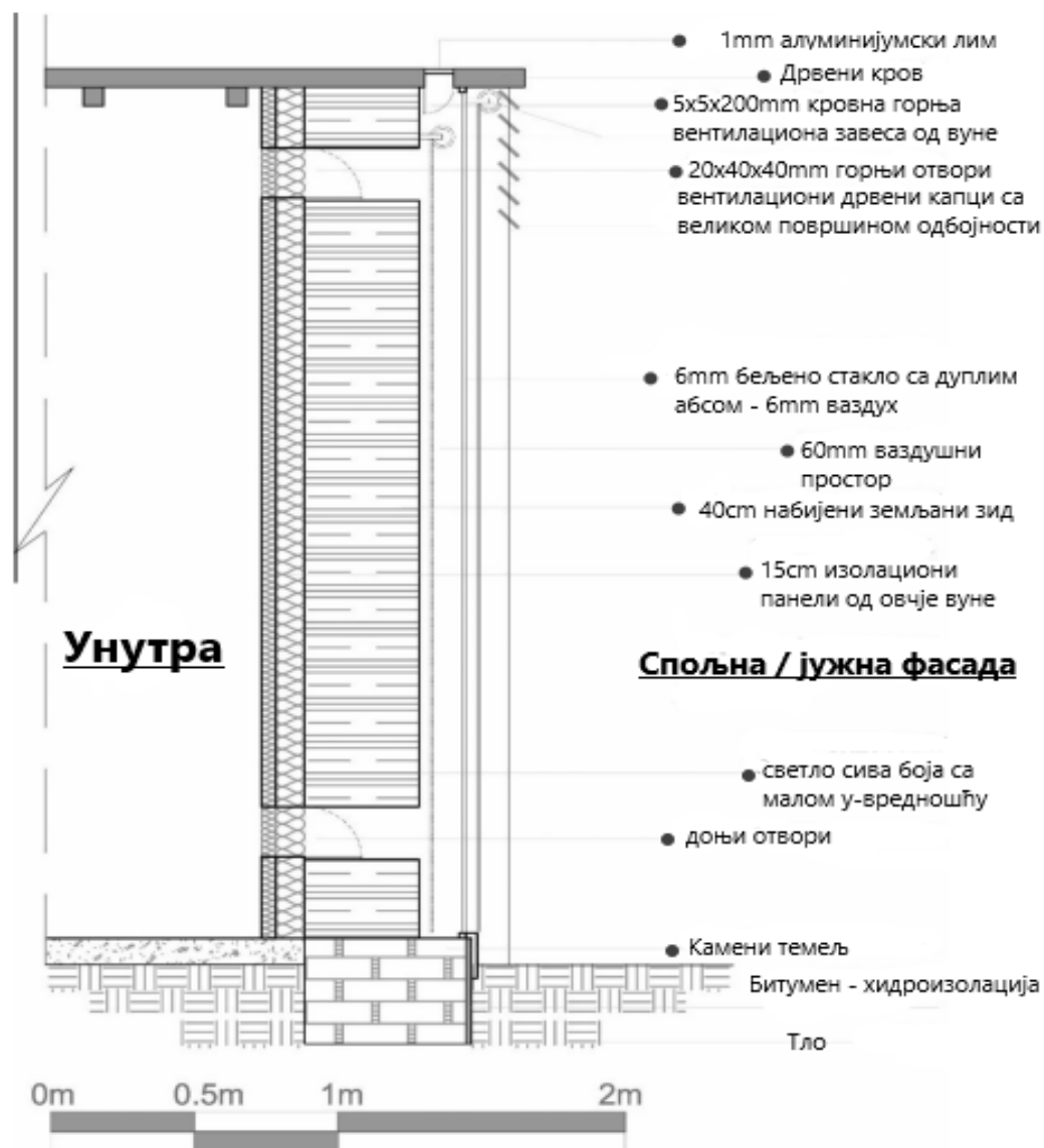
Слика 47. Пресек предложеног Тромбовог зида [18]
