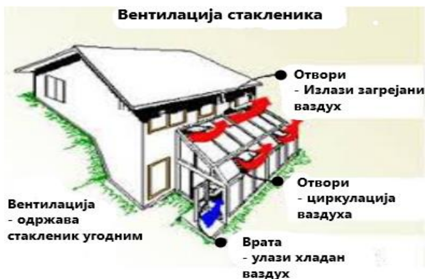
Слика 20. Приказ функционисања вентилације стакленика [11]
