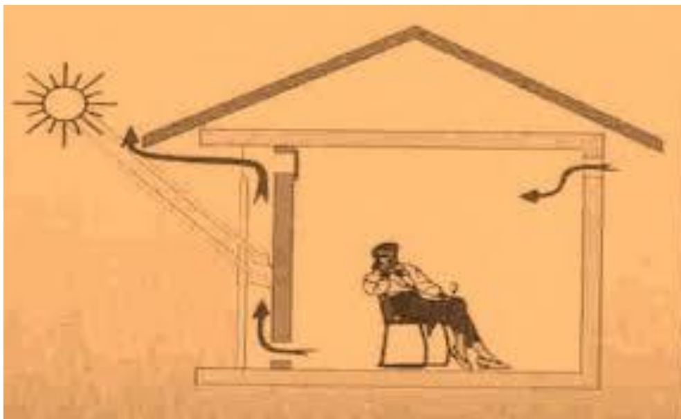
Слика 29. Кондиционирање пасивног соларног система [14]
