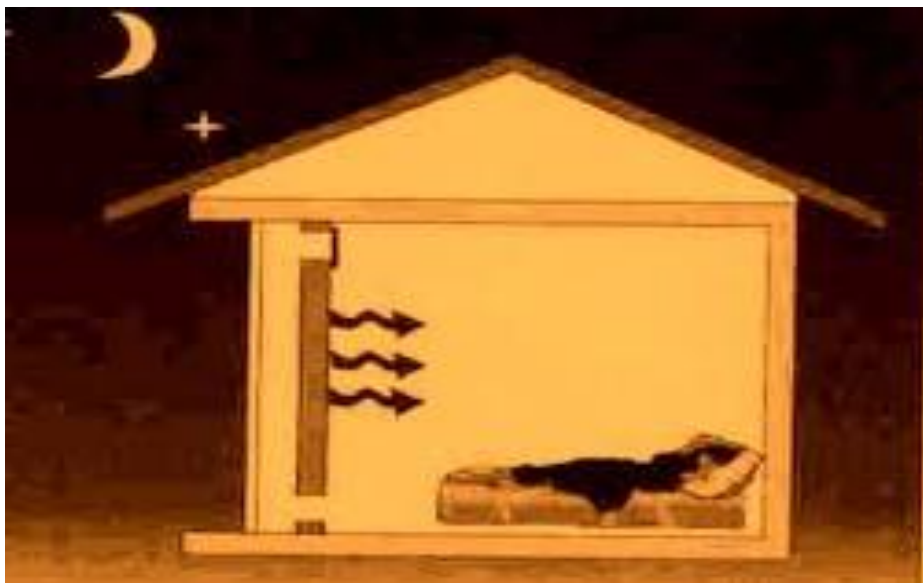
Слика 27. Зрачење Тромбовог зида током ноћи [14]
