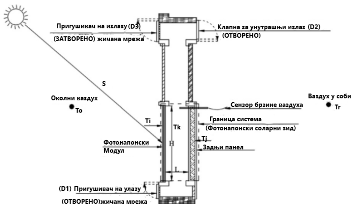
Слика 44. Детаљи Фотонапонског (PV) Тромбовог зида [16]
