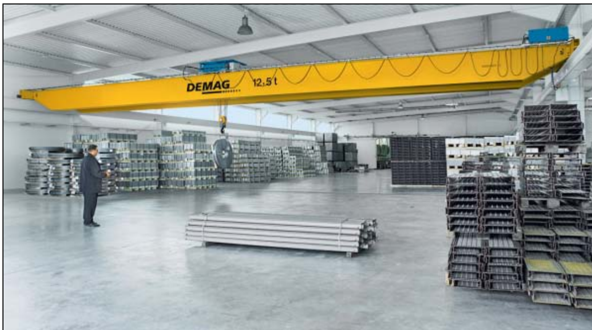
Слика 1 - Демаг мосна дизалица носивости 12.5t (Кливенд, САД) [1]
