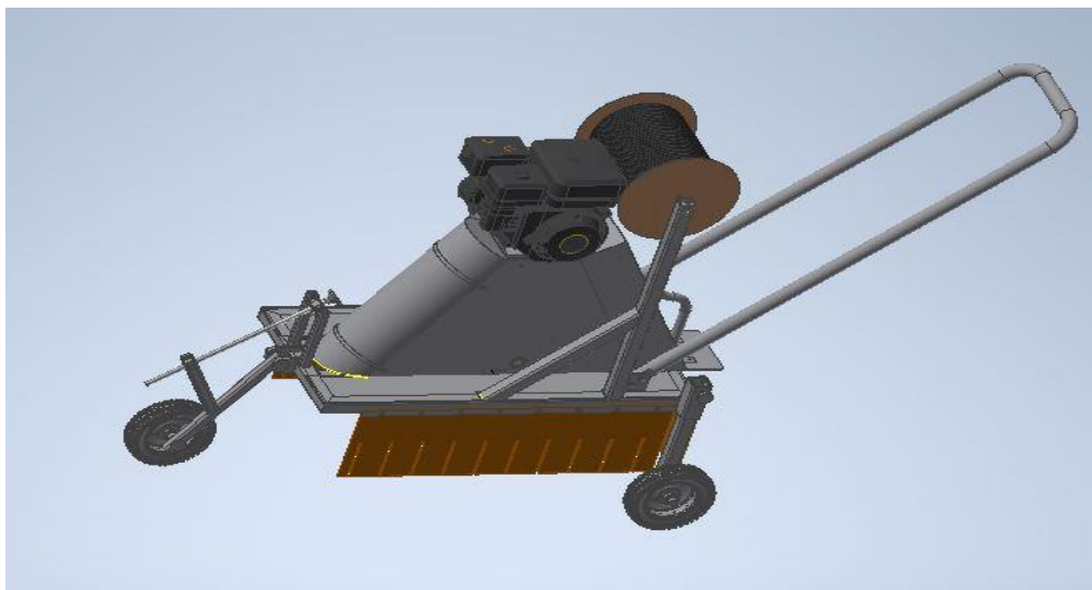
Слика 17. Машина за укопавање каблова
