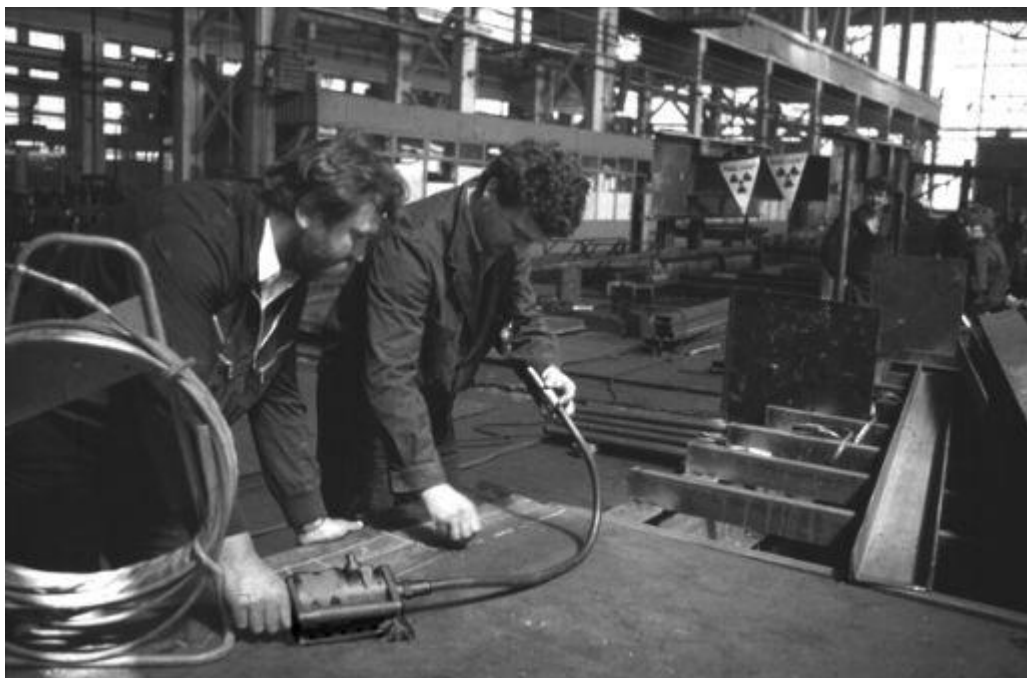
Слика 10. Рендген уређај за радиографску контролу [L2]
