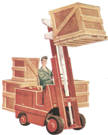
Слика 44. Покретна колица обојена бојом опомене [1]
