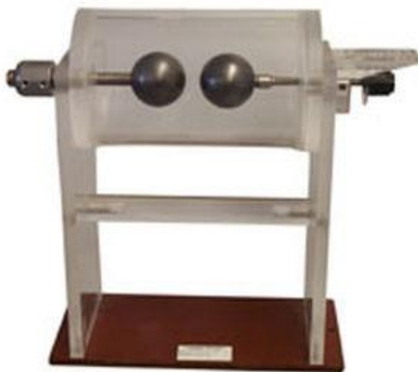
Слика 1.7: Варничар, проста конструкција
