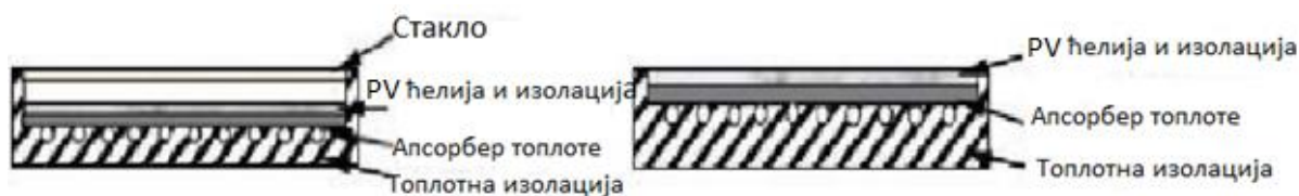
Слика 13. Основна структура течног PV/T колектора (застакљени колектор лево, незастакљени десно) [28]
