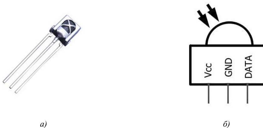
Слика 8. Инфрацрвени сензор AX-1838HS а) физички изглед, б) шематски приказ [4]
