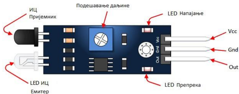
Слика 10. FC-51 сензор са обележеним ознакама компоненти и прикључака [5]
