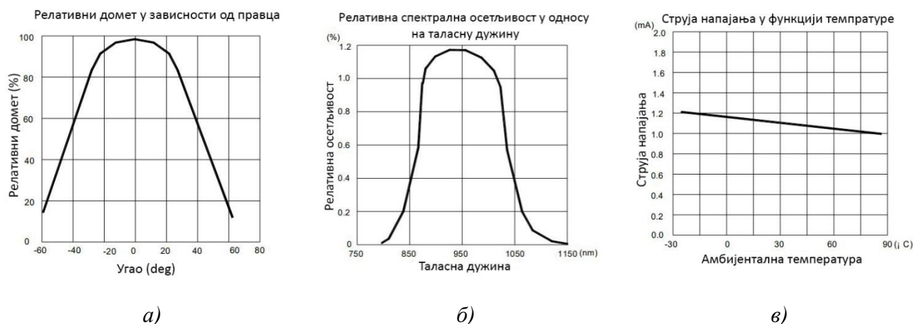
Слика 9. Карактеристике релеја а) Релативни домет у зависности од правца, б) Релативна спектрална осетљивости у функцији таласне дужине, в) Промена струје напајања у функцији температуре [4]
