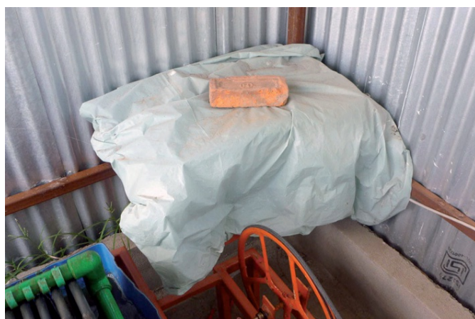
Слика 8.7. Акумулатор, пуњач и исправљач напона су покривени пластичном фолијом да их заштити од кише и других атмосферских услова [18]
