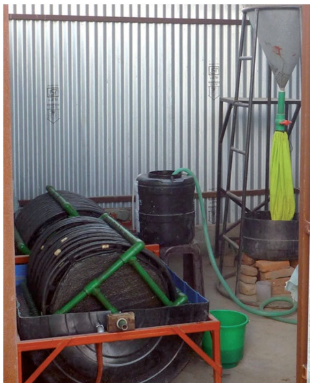
Слика 8.1. Ротирајући биолошки контрактор за третман урина [18]
