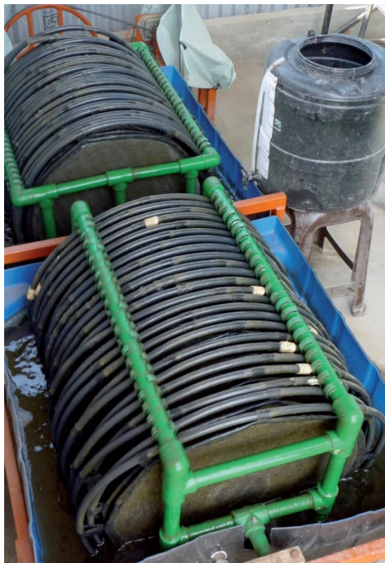
Слика 8.3. Ротирајући биолошки контрактор за третман урина [18]
