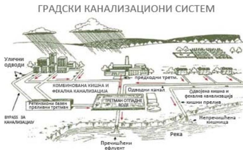
Слика 2.1. Градски канализациони систем [1]
