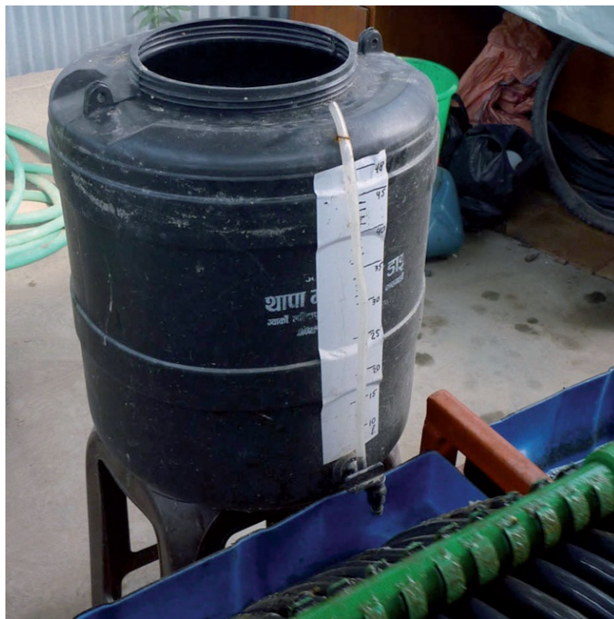
Слика 8.4. RBC приливни резервоар са индикатором нивоа попуње и одводног вентила према реактору [18]
