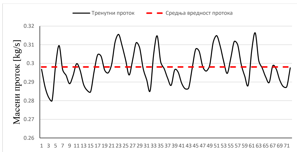
Слика 6.13 Вредност масеног протока и приказ степена неравномерности (CFX)
