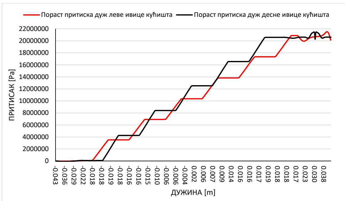
Слика 6.6 Распоред притиска дуж ивица кућишта (Fluent)
