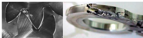
Слика 1.4. Пример настанка кавитације при спрезању зупчаника, оштећење чеоне плоче услед кавитације [6]
