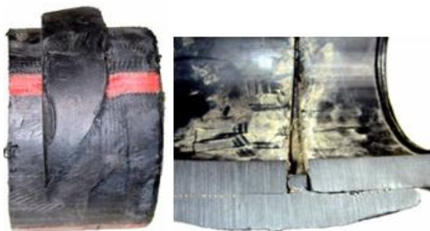
Слика 61. Грешке настале услед неправилног извођења процеса спајања пластичних цеви електричним фитингом
