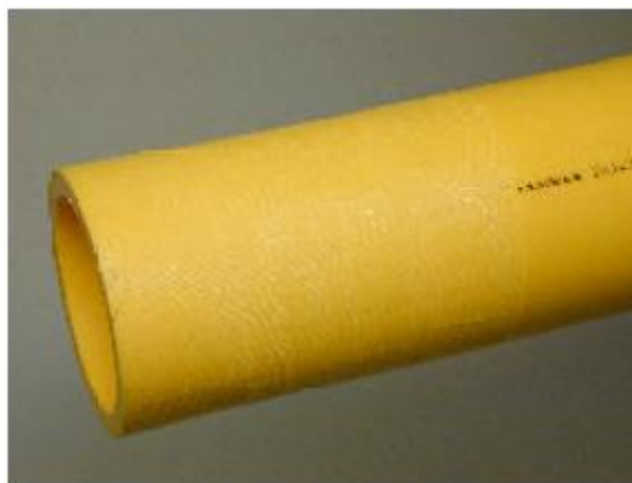
Слика 54. Припремљена површина цеви за уградњу
