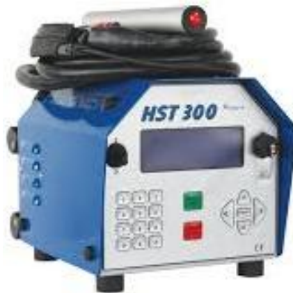
Слика 47. Машина за електрофузионо заваривање HST 300 Pricon+ [9]
