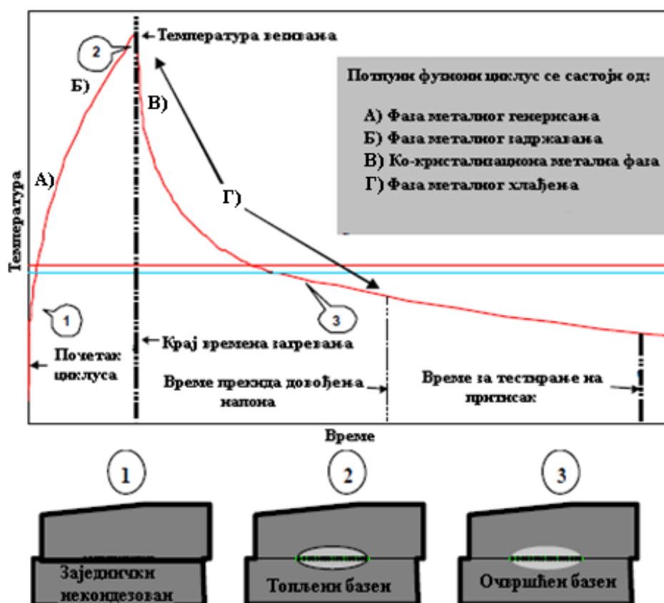
Слика 48. Приказ растопљеног базена
