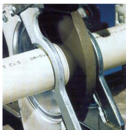
Слика 27. Грејање помоћу топлоталата-пегле
