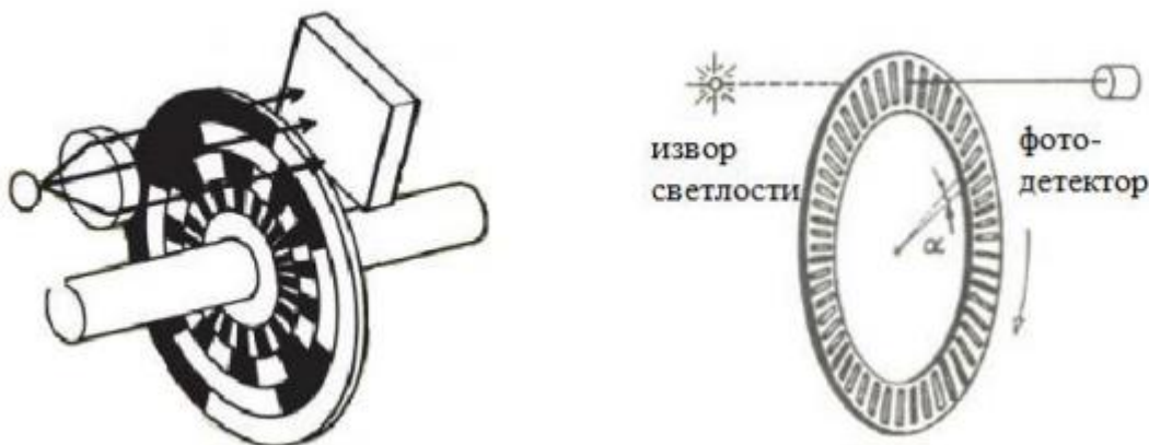
Слика 9 – Приказ апсолутног (лево) и инкременталног(десно) енкодера[7]
