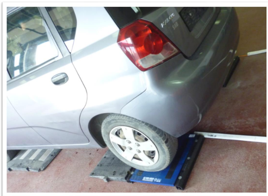
Слика 38. Мерење осовинског оптерећења задње осовине возила Chevrolet Kalos
