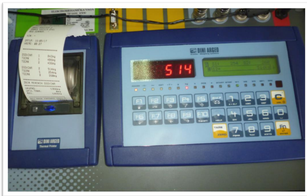
Слика 44. Измерена вредност осовинског оптерећења на задњој осовини возила Opel Meriva
