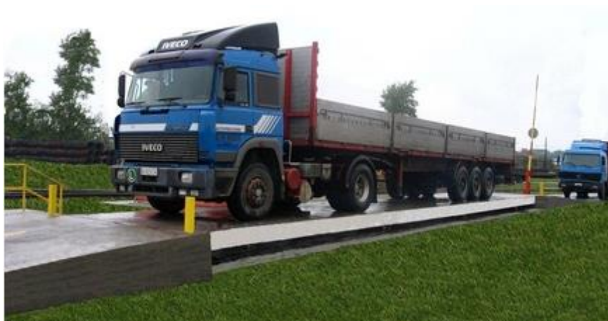
Слика 12. Тепих вага са бетонским мостом [12]
