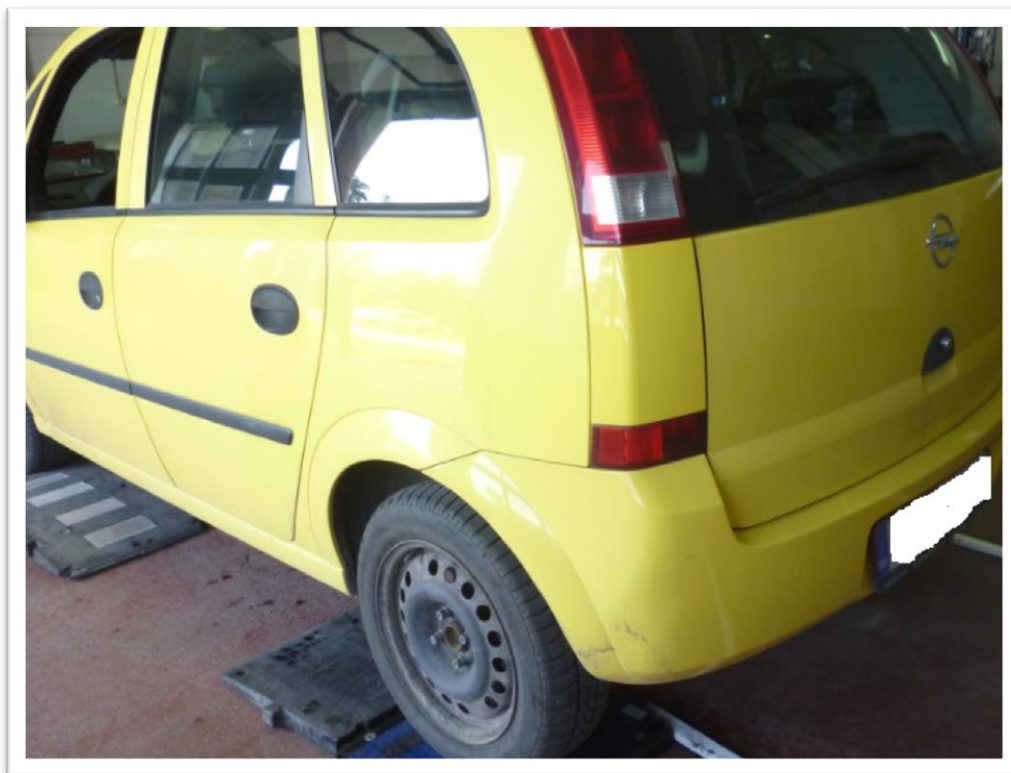
Слика 43. Мерење осовинског оптерећења задње осовине возила Opel Meriva
