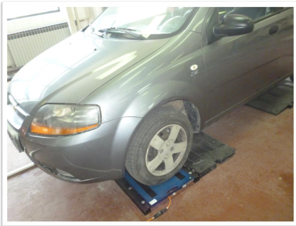
Слика 36. Мерење осовинског оптерећења предње осовине возила Chevrolet Kalos
