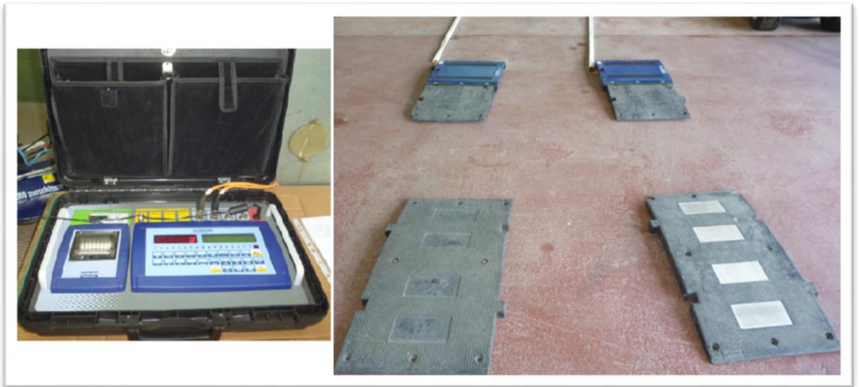
Слика 33. Приказ мерне инсталације - мерни индикатор (лево), мерне платформе са наулазним рампама (десно)
