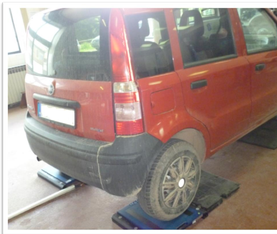
Слика 47. Мерење осовинског оптерећења задње осовине возила Fiat Panda
