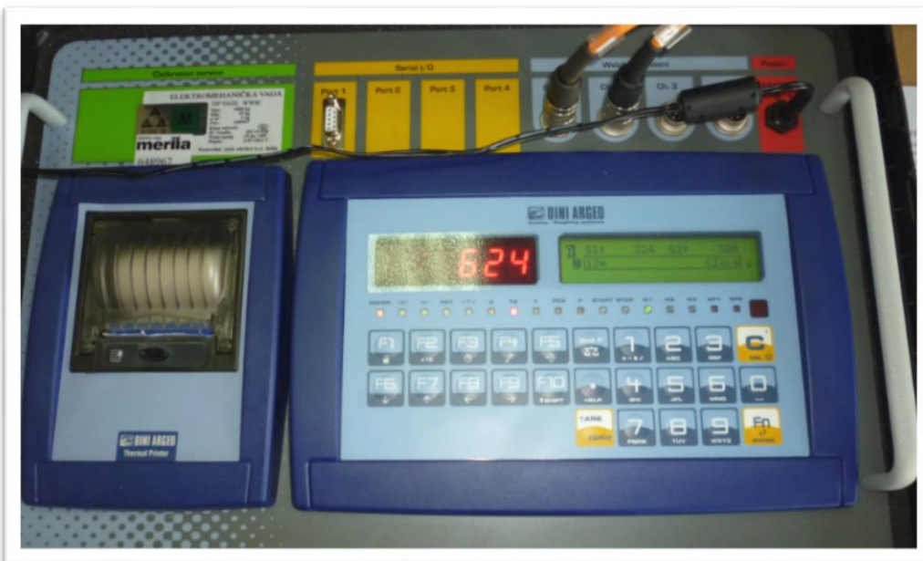
Слика 37. Измерена вредност осовинског оптерећења на предњој осовини возила Chevrolet Kalos
