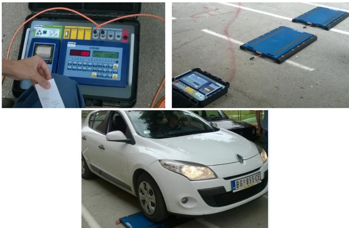
Слика 9. Мерне ваге за мерење осовинског оптерећења са основним елементима [9]
