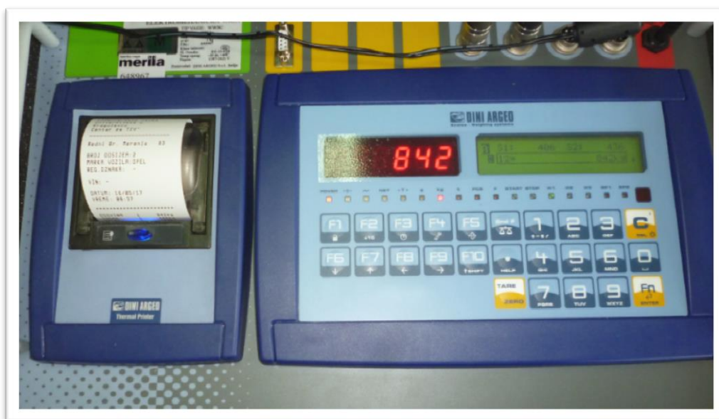
Слика 42. Измерена вредност осовинског оптерећења на предњој осовини возила Opel Meriva
