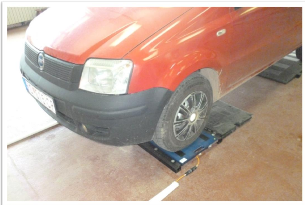
Слика 45. Мерење осовинског оптерећења предње осовине возила Fiat Panda
