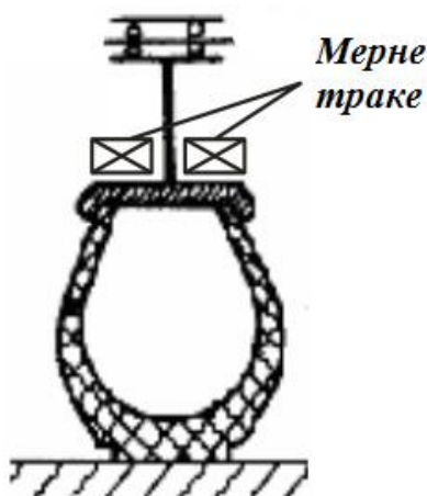
Слика 6. Мерење динамичких сила на точковима мерењем деформација обода точка, приказ постављања мерних трака [6]
