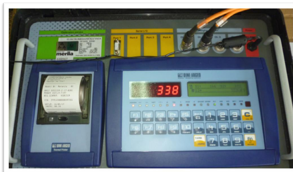
Слика 48. Измерена вредност осовинског оптерећења на задњој осовини возила Fiat Panda
