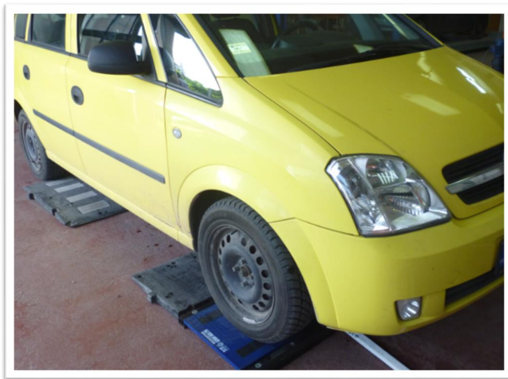
Слика 41. Мерење осовинског оптерећења предње осовине возила Opel Meriva
