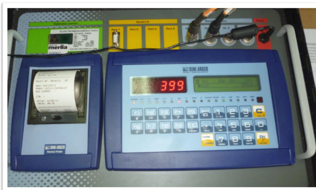
Слика 39. Измерена вредност осовинског оптерећења на задњој осовини возила Chevrolet Kalos
