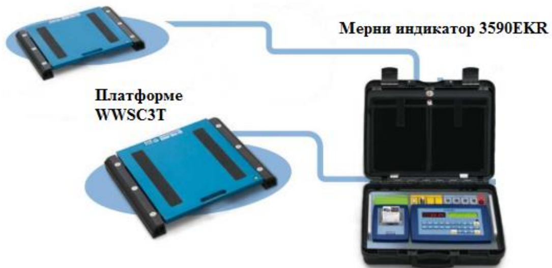
Слика 30. Изглед мерног система - ваге за мерење осовинског оптерећења [18]
