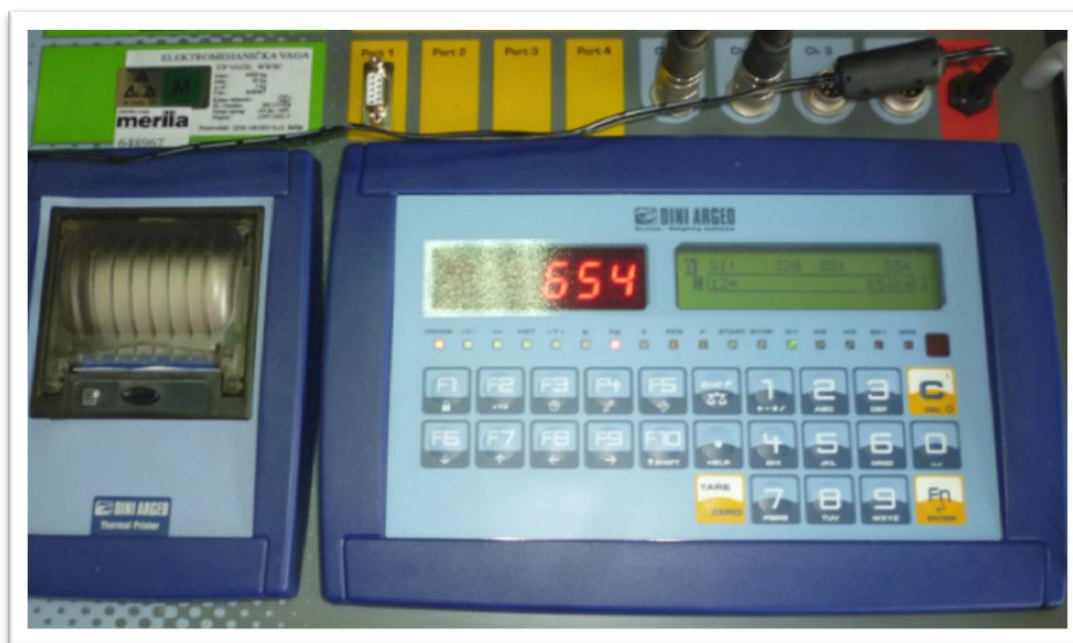
Слика 46. Измерена вредност осовинског оптерећења на предњој осовини возила Fiat Panda
