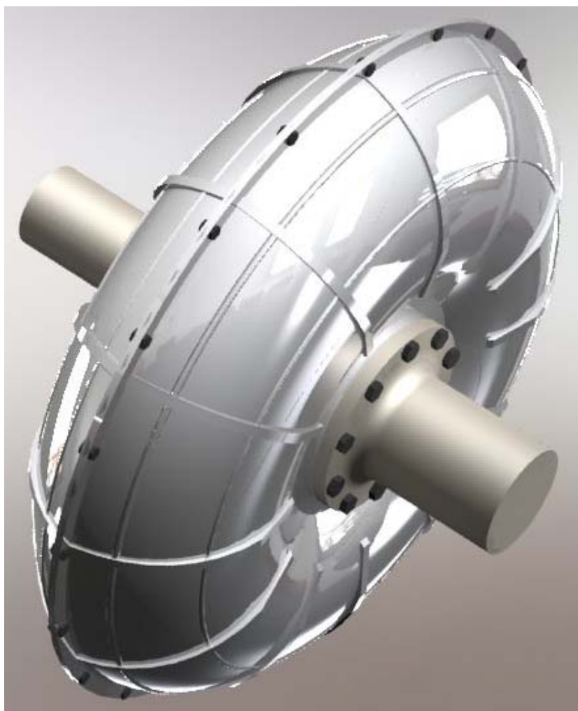
Слика 6.1- 3Д модел склопљене хидродинамичке спојнице
