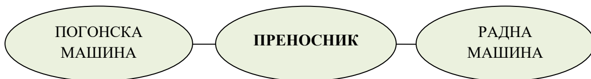
Слика 1.1 Шема погонске машине, преносник, радна машина
