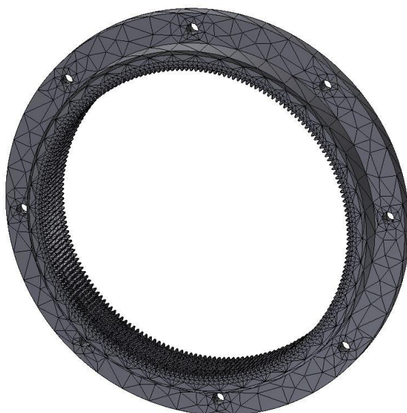
Слика 5.13 Избор мреже коначних елемената на чврстом зупчанику
