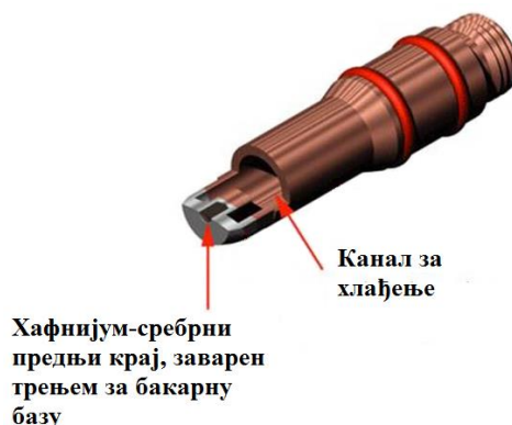
Слика 33. Електрода хафнијум-сребром, [11]
