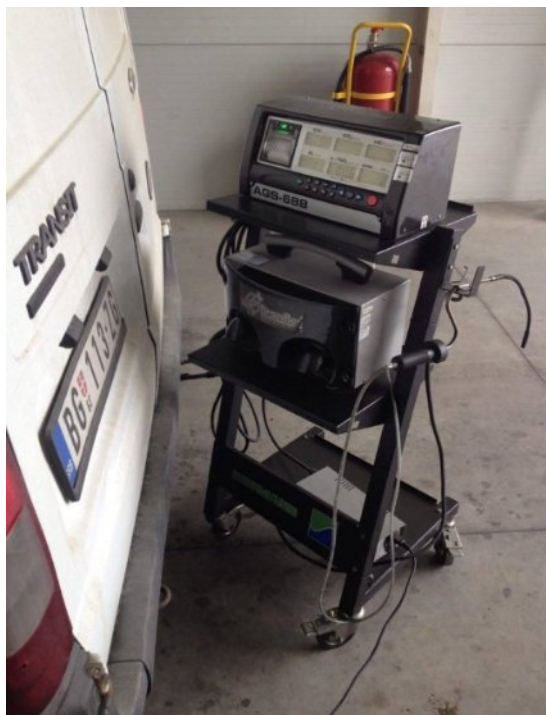
Слика 2.6. Уређаја за мерење емисије издувних гасова – анализатор гаса и смокекетар или димометар
