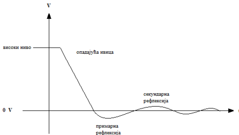
Слика 7 Осциловање сигнала код преласка са високо на ниско [3]
