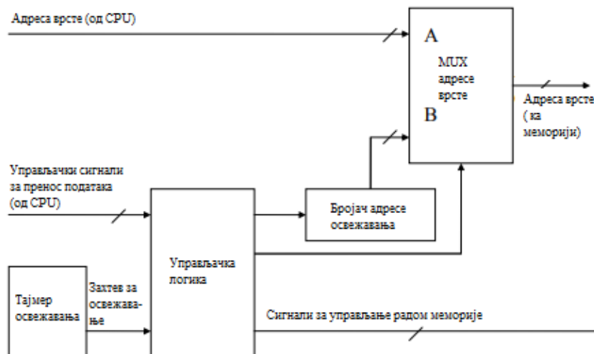
Слика 6 Шема структуре за освежавање DRAM-а [4]
