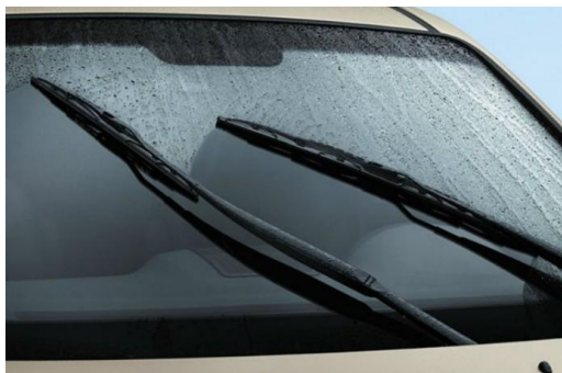
Сл.28 Истосмерно кретање брисача код аутомобила [12]
