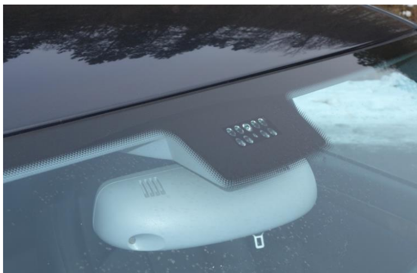
Сл. 39 Сензор за кишу на ветробранском стаклу [7]
