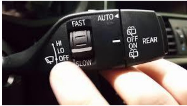
Сл.30 Подешавање брзине кретања метлица брисача [12]
