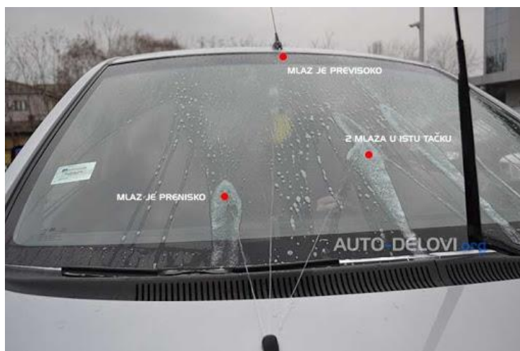
Сл. 41 Млаз течности за прање ветробранског стакла[8]
