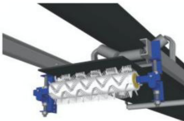
Слика 7.4 Уређај за чишћење са четкама
