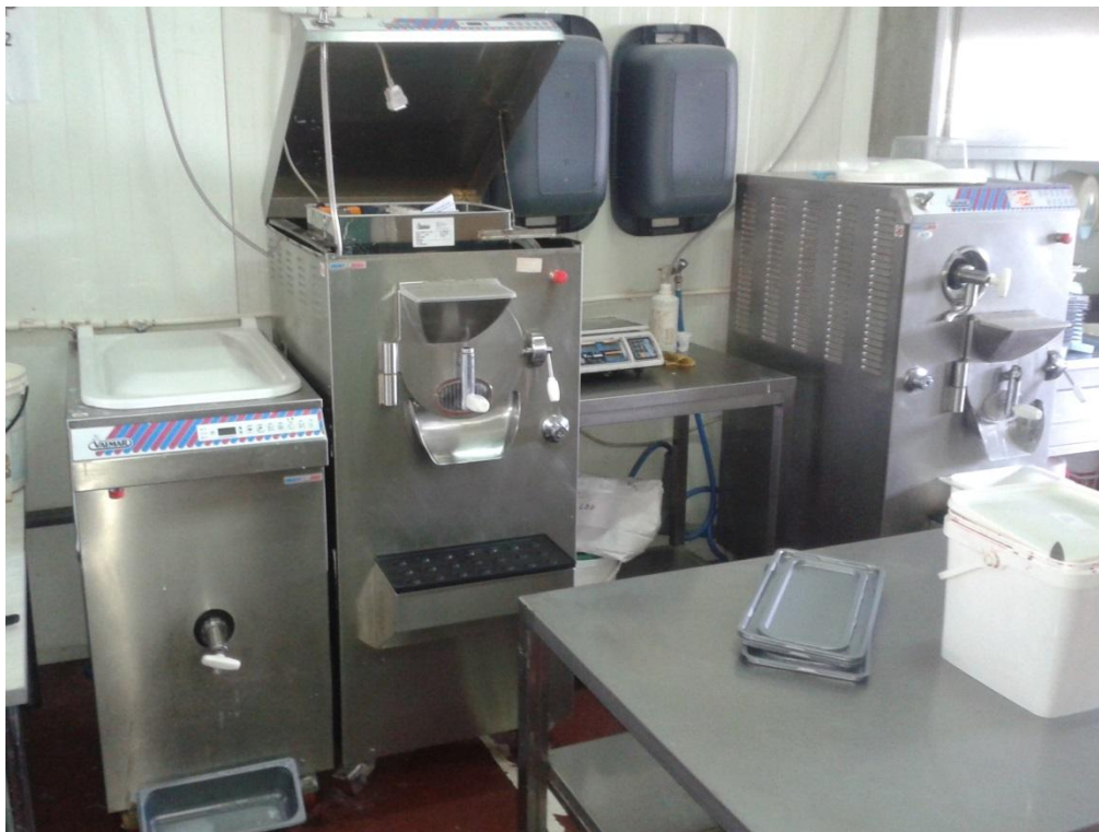
Слика 17. Пастеризатор, машине за мешање сладоледа
