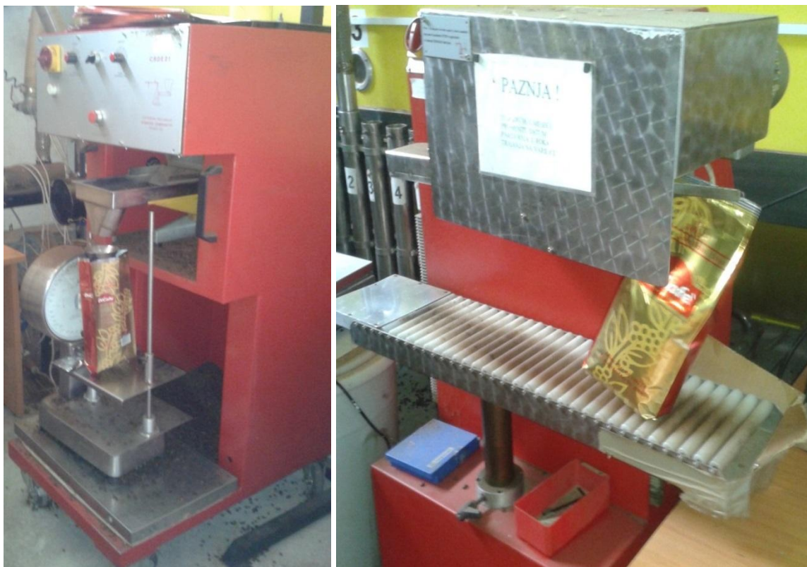
Слика 15. Машина за паковање кафе и машина за варење кеса
