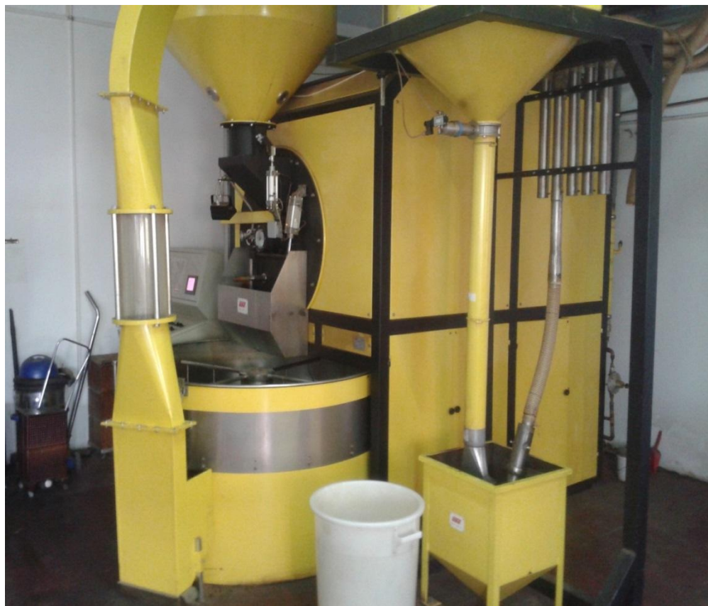
Слика 13. Машина - Футура за пржење и хлађење кафе
