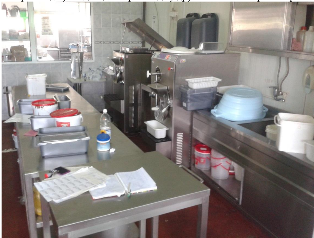
Слика 16. Линија за производњу сладоледа и других посластичарских производа
