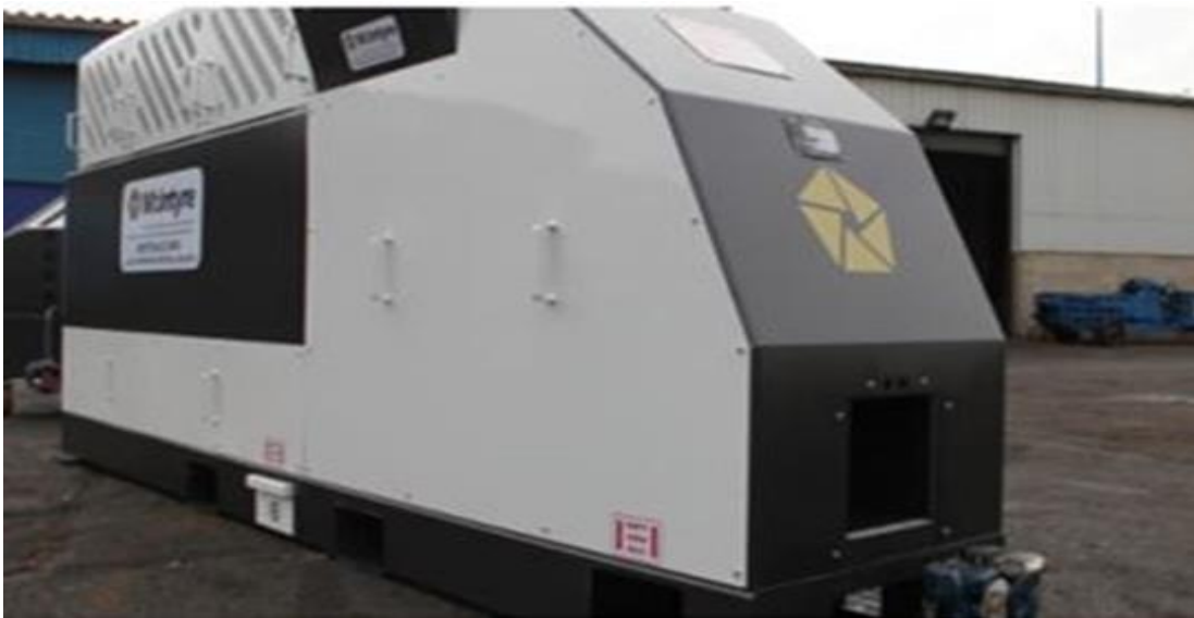
Слика 10 - Metallican вишенаменска преса за метални отпад и уљне филтере [13]
