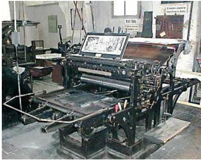
Слика 2.3. Модел цилиндарске штампарске машине из 1812.год. [5]
