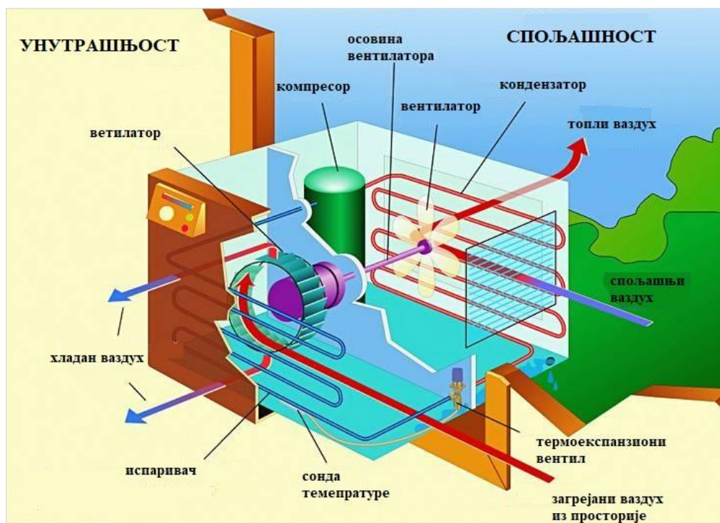
Слика 21. Принцип функционисања прозорског кондиционера [18]
