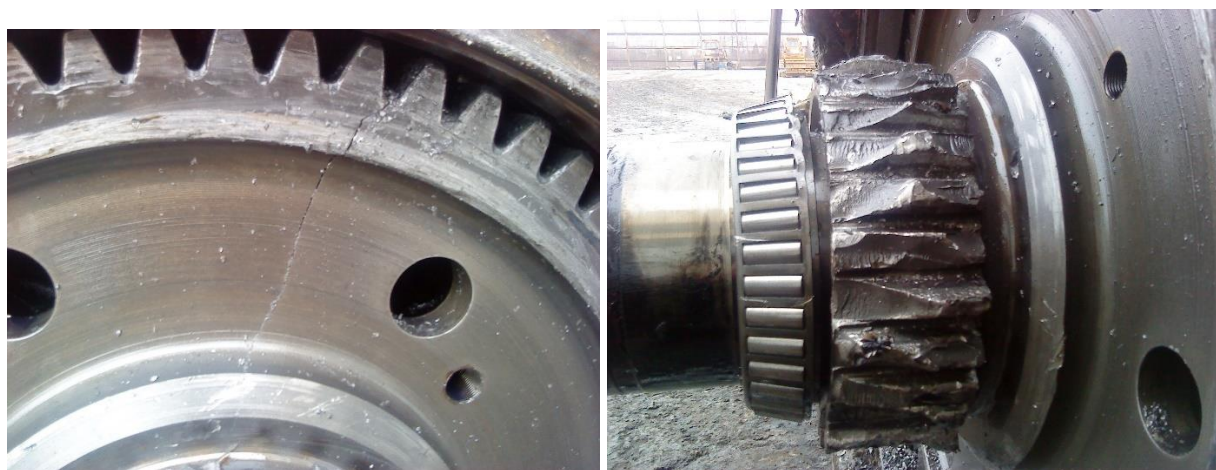
Слика 42. Лом погонског и сунчаног зупчаника
