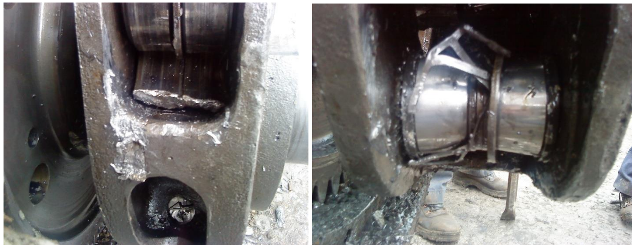
Слика41. Пуцање планетарних зупчаника
