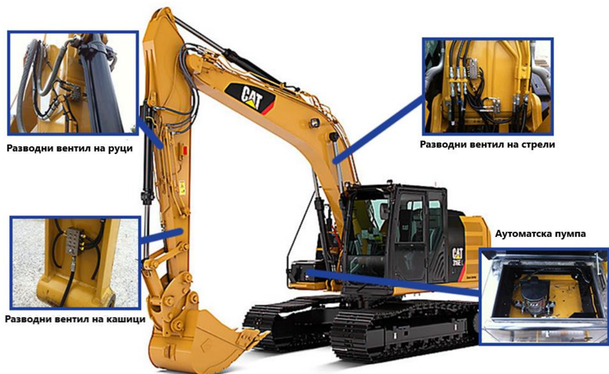
Слика 45. Централно подмазивање хидрауличног багера[15]
