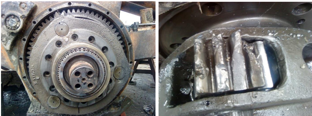
Слика 40. Лом зуба зупчаника планетарног редуктора погона
