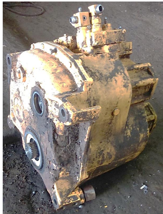
Слика 33. Хидраулични мењач типа “Power Shift” –омогућава промену брзина под пуним оптерећењем
