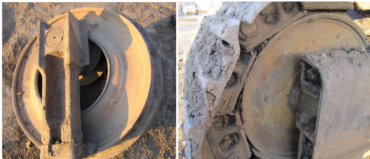
Слика 37. Оштећење затезног точка гусеничног ланца као последица заривавања клизних лежајева
