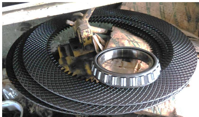
Слика 34. Фрикциони пар за пренос снаге
