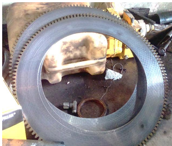
Слика 34. Фрикциони пар за пренос снаге
