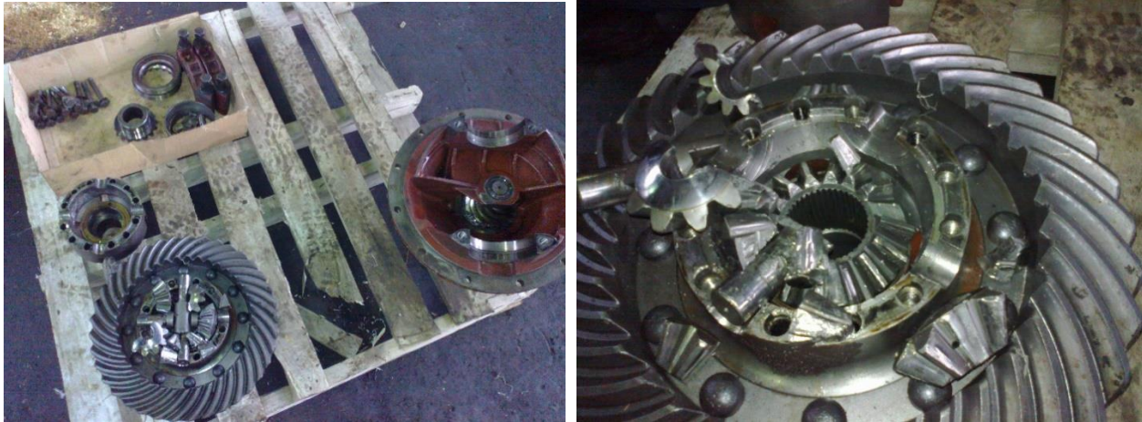
Слика 39. Квар предњег диференцијала утоварне лопате као последица пуцања зупчаника
