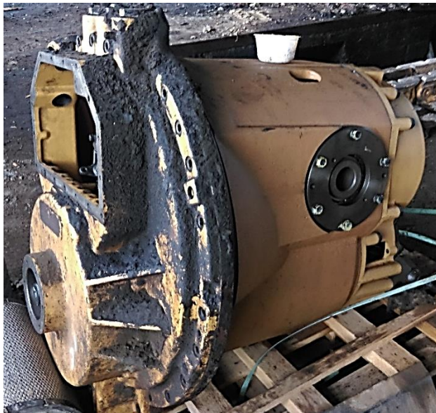
Слика 33. Хидраулични мењач типа “Power Shift” –омогућава промену брзина под пуним оптерећењем
