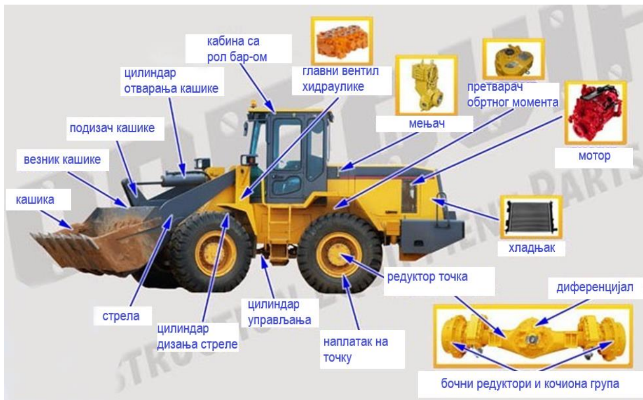
Слика 24. Компоненте утоваривача [12]
