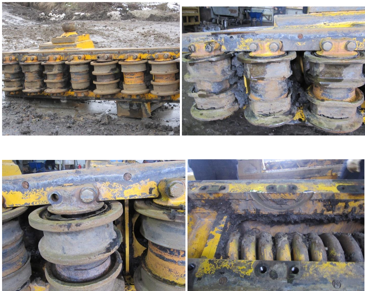
Слика 36. Хабање доњих ролни гусеничног ланца
