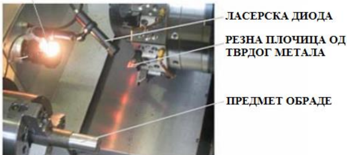
Слика 3.2 - Мерни сет постављен на алатној машини[11]
