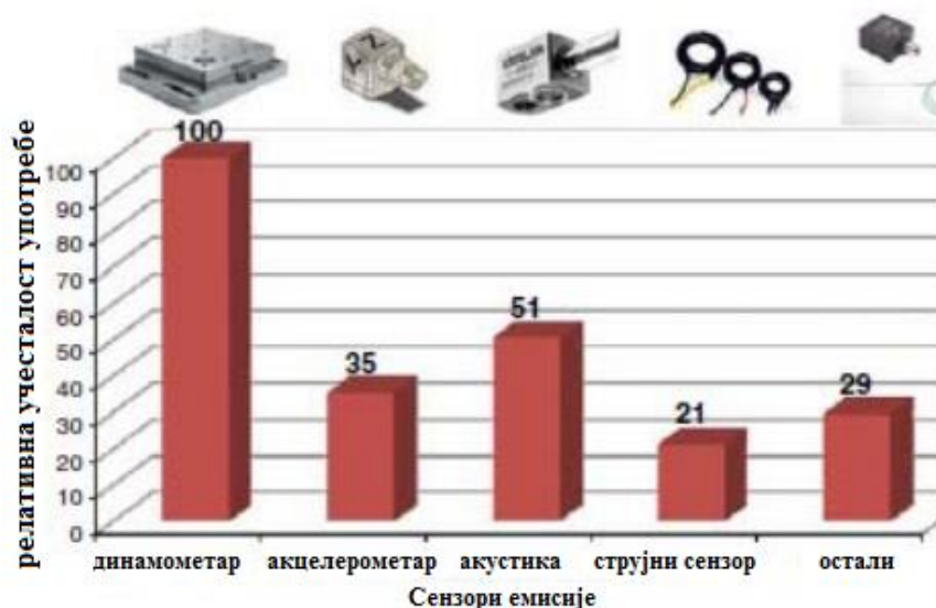
Слика 2.10 - Учестаност употребе сензора у системима мониторинга машине[11]
