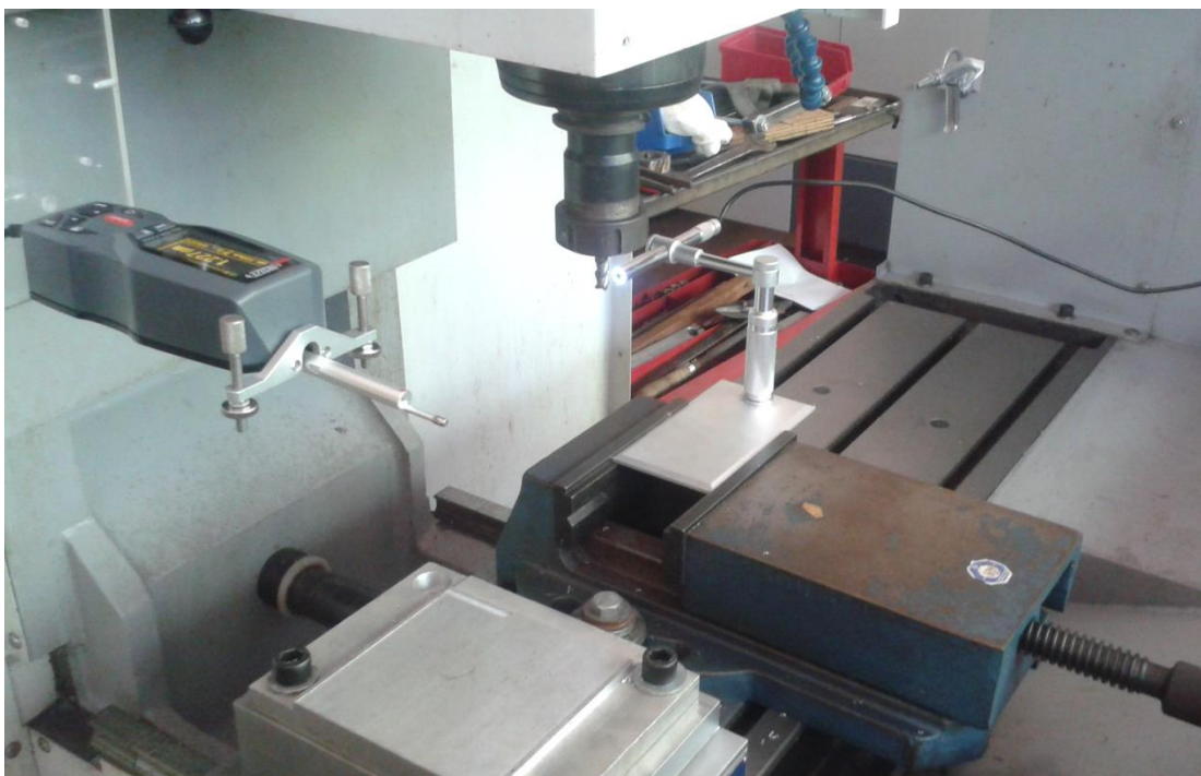
Слика 4.6 - Положај уређаја за мерење храпавости површине и микроскоп камере
