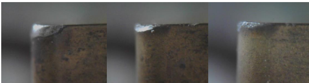
Слика 3.5 - Похабане површине резне плочице 1[7]
