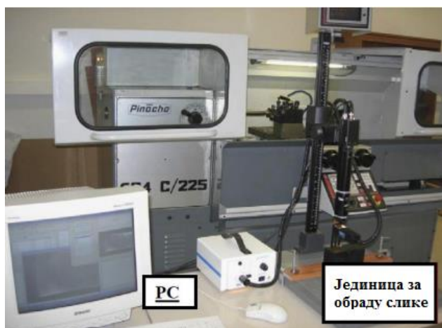
Слика 3.20 – Мониторинг хабања алата путем процесуирања слике[14]
