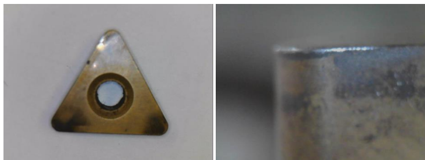
Слика 3.6 - Резна плочица 2 и похабана површина[7]
