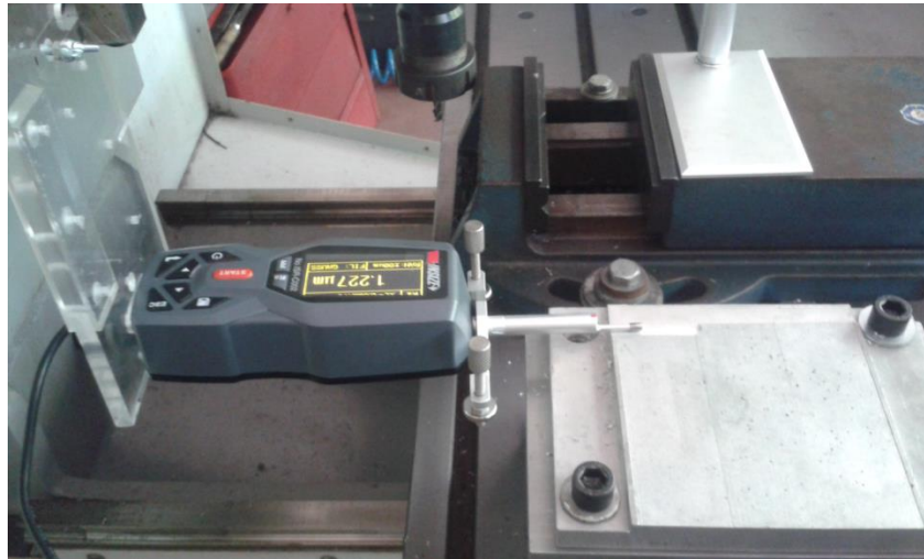
Слика 5.10 – Мерење параметара храпавости након првог пролаза обраде глодањем
