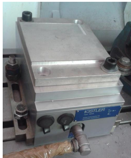
Слика 4.4 - Диамометар "Kistler - Тип 9265A1" са предметом обраде
