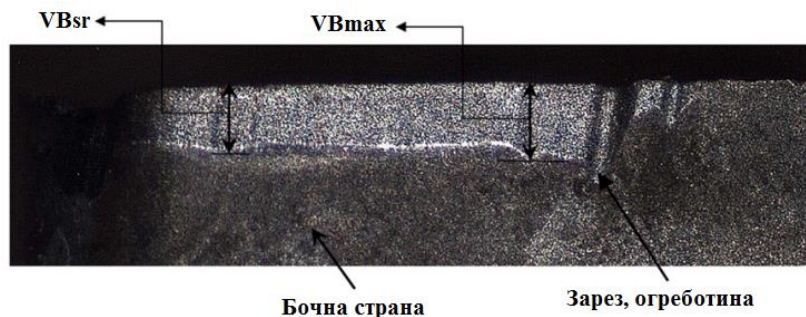
Слика 3.1 - Хабање леђне површине алата у виду појаса хабања и зареза[5]
