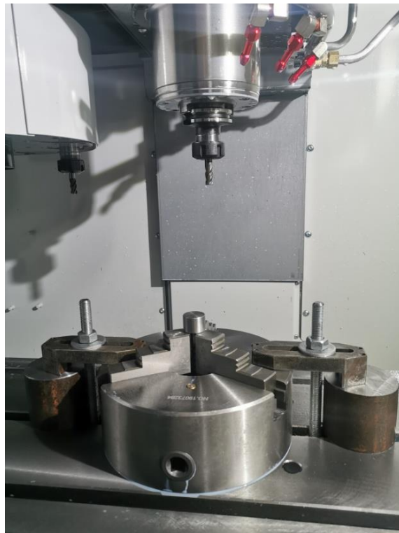
Слика 4.2 – Стезни прибор коришћен у експерименту
