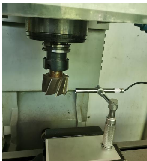
Слика 5.4 – Положај камере и глодала
