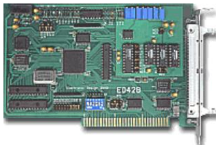
Слика 2.8 – Модул за аквизицију сигнала система за мониторинг и управљање[8]
