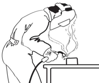
Слика 3 - Опасне материје пролазе кроз зону дисања
