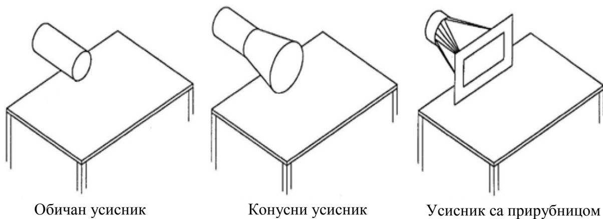
Слика 13 - Врсте усисника на мобилним рукама за одсисавање ваздуха
