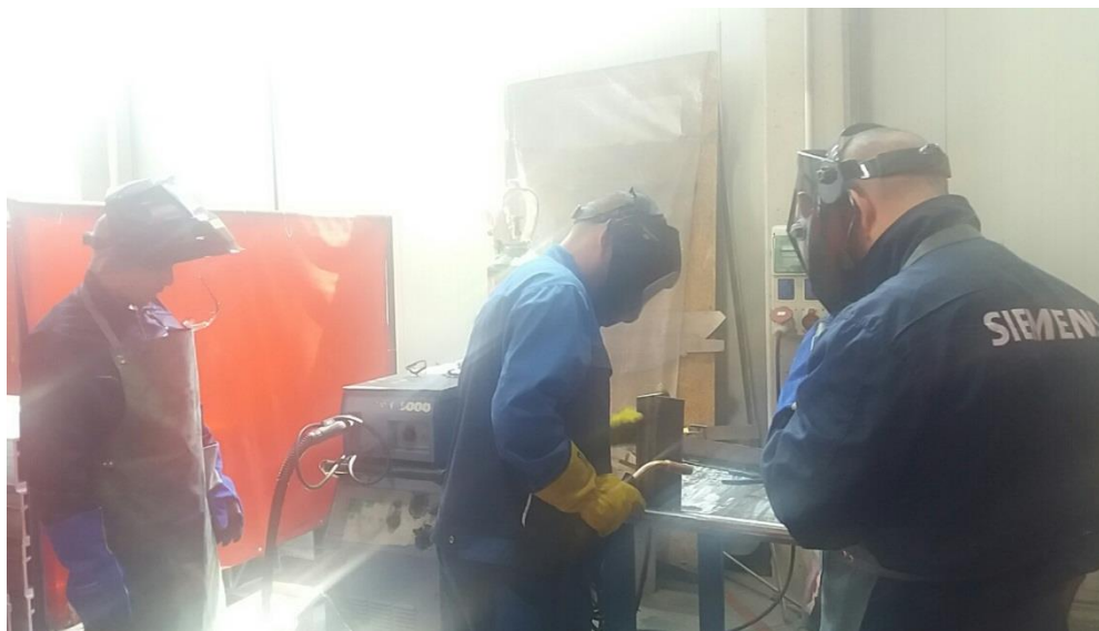
Слика 5 - Процес заваривања и лична заштитна средства
