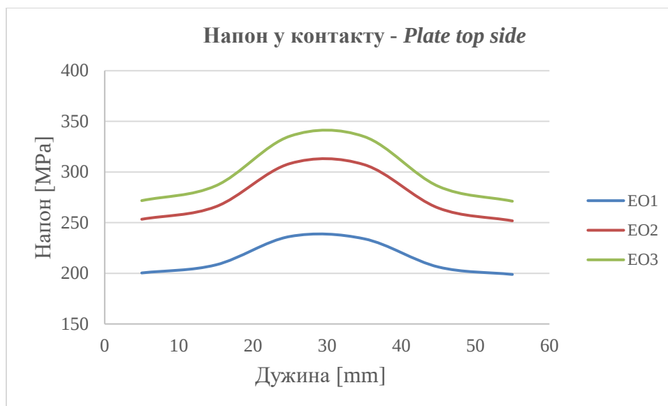
Слика 7.39 Густина мреже 10 mm x 5 mm - Промена напона у контактном региону у зависности од ЕО
