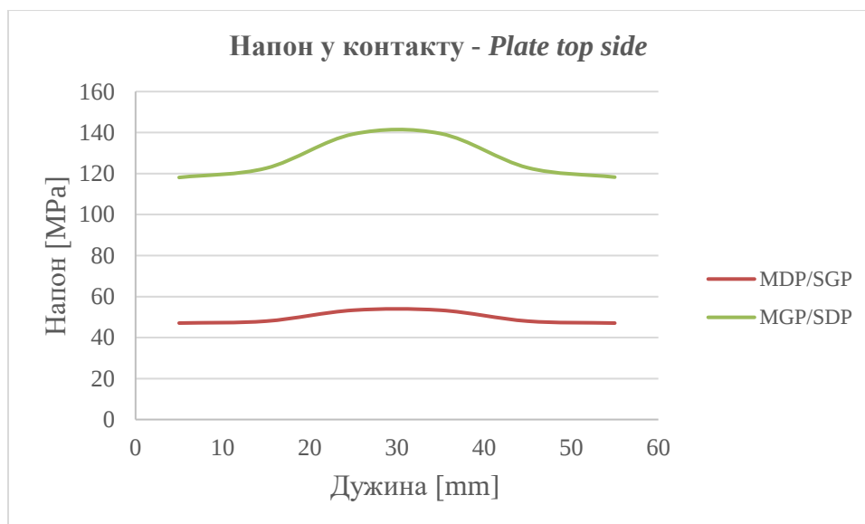
Слика 7.48 Густина мреже 10 mm x 10 mm - Промена напона у контактном региону у зависности од положаја master/slave сегмента, где су: MDP – master доњи полукруг, SGP – slave горњи полукруг, MGP – master горњи полукруг и SDP – slave доњи полукруг
