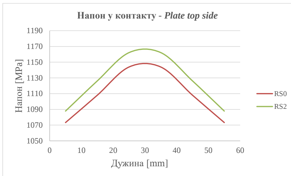
Слика 6.19 Густина мреже 10 mm x 10 mm - Промена напона у контактном региону у зависности од RS
