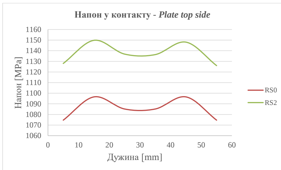
Слика 8.12 Густина мреже 10 mm x 10 mm - Промена напона у контактном региону у зависности од RS
