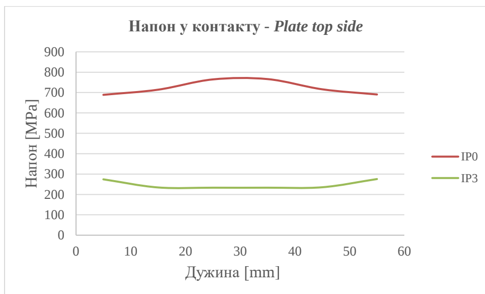
Слика 6.41 Густина мреже 10 mm x 10 mm - Промена напона у контактном региону у зависности од IP
