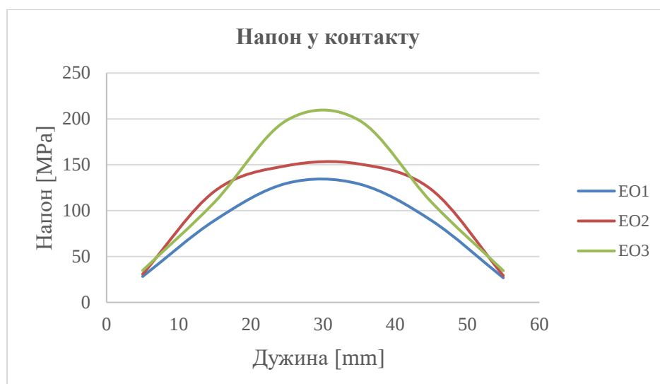
Слика 6.6 Густина мреже 10 mm x 20 mm - Промена напона у контактној региону у зависности од ЕО
