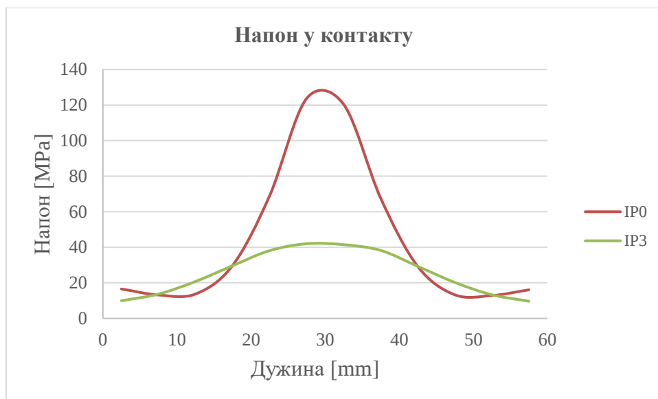
Слика 7.10 Густина мреже 10 mm x 5 mm - Промена напона у контактној региону у зависности од IP
