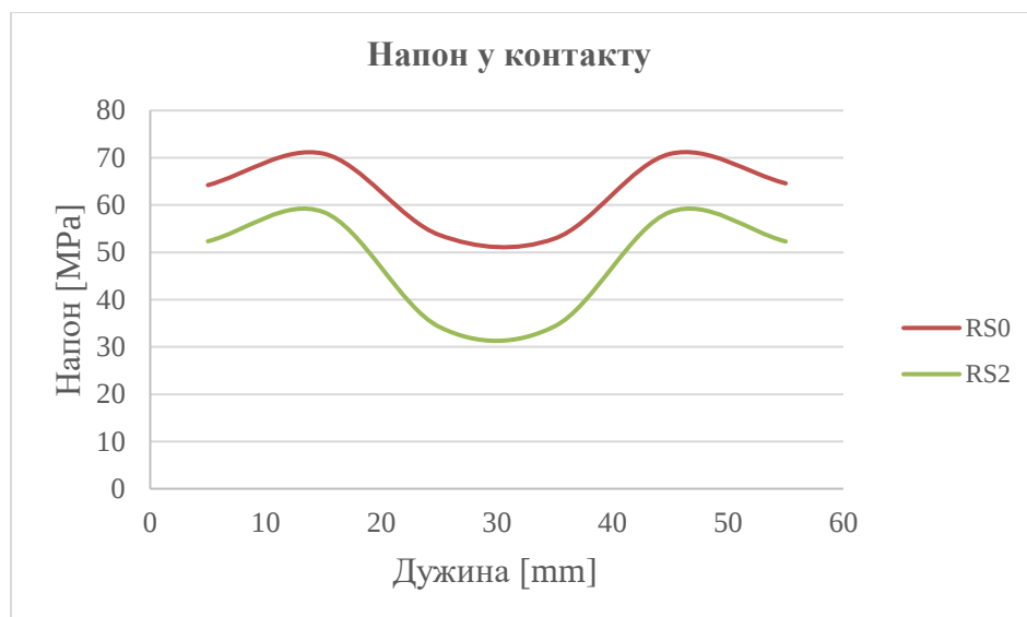
Слика 5.45 Густина мреже 10 mm x 20 mm - Промена напона у контактном региону у зависности од RS
