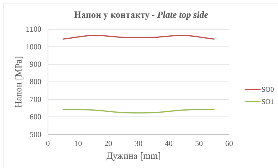
Слика 8.37 Густина мреже 10 mm x 5 mm - Промена напона у контактном региону у зависности од SO
