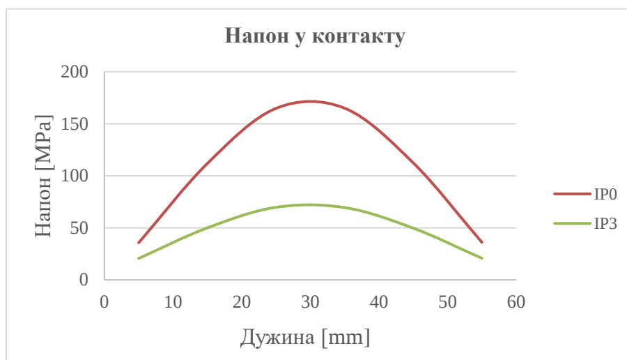
Слика 6.10 Густина мреже 10 mm x 5 mm - Промена напона у контактној региону у зависности од IP
