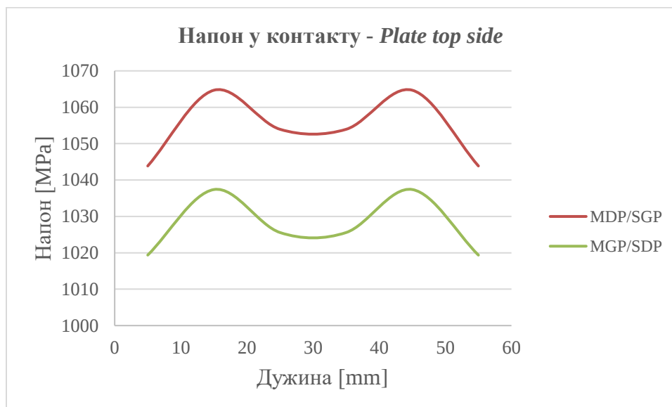
Слика 8.43 Густина мреже 10 mm x 5 mm - Промена напона у контактном региону у зависности од положаја master/slave сегмента, где су: MDP – master доњи полукруг, SGP – slave горњи полукруг, MGP – master горњи полукруг и SDP – slave доњи полукруг
