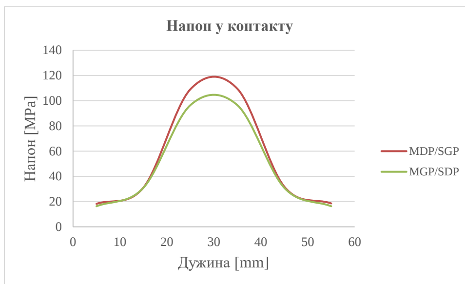
Слика 7.12 Густина мреже 10 mm x 5 mm - Промена напона у контактној региону у зависности од положаја master/slave сегмента, где су: MDP – master доњи полукруг, SGP – slave горњи полукруг, MGP – master горњи полукруг и SDP – slave доњи полукруг
