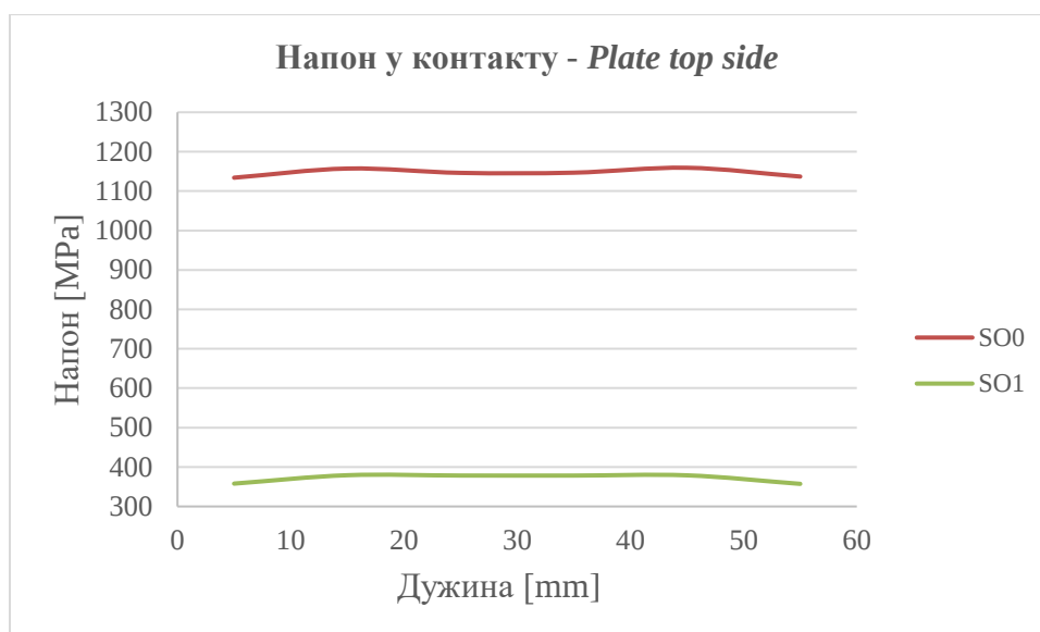
Слика 8.15 Густина мреже 10 mm x 5 mm - Промена напона у контактном региону у зависности од SO
