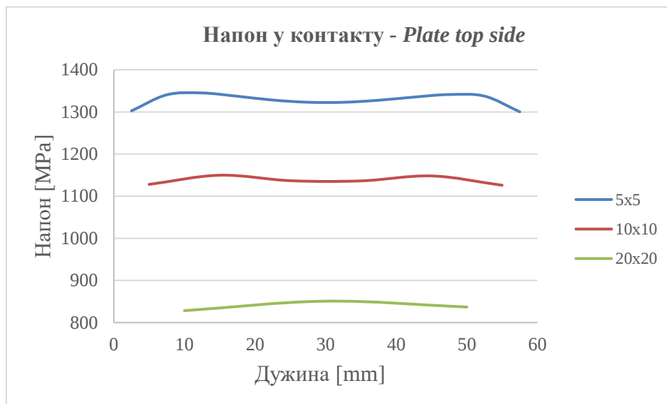
Слика 8.9 Промена напона у контактном региону у зависности од густине мреже
