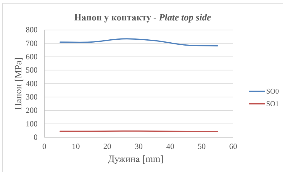
Слика 5.35 Густина мреже 10 mm x 10 mm - Промена напона у контактном региону у зависности од SO
