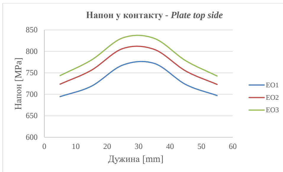
Слика 6.32 Густина мреже 10 mm x 5 mm - Промена напона у контактном региону у зависности од ЕО
