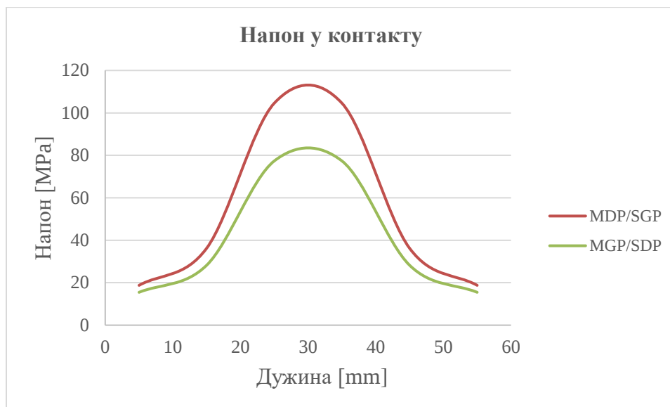
Слика 7.60 Густина мреже 10 mm x 10 mm - Промена напона у контактној региону у зависности од master/slave сегмента, где су: MDP – master доњи полукруг, SGP – slave горњи полукруг, MGP – master горњи полукруг и SDP – slave доњи полукруг
