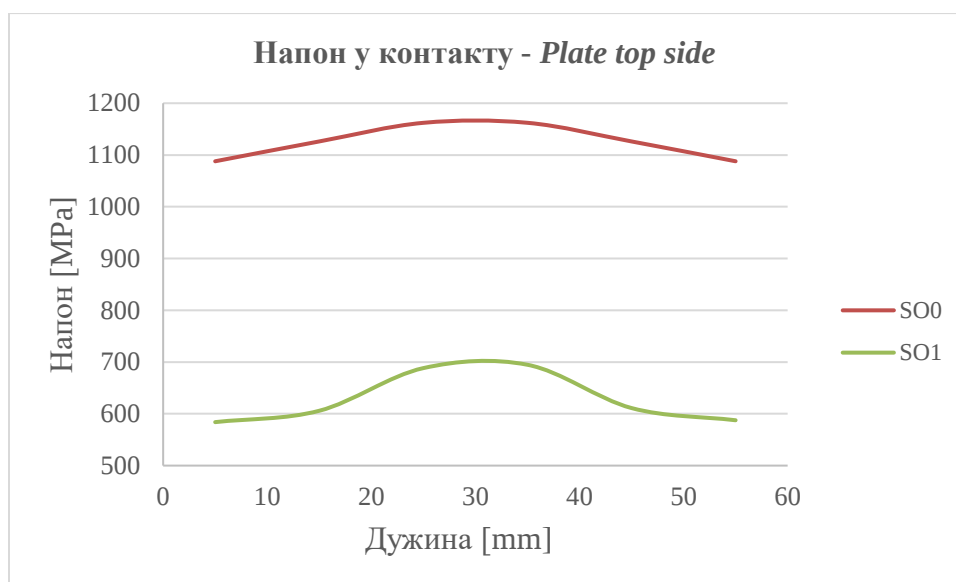
Слика 6.22 Густина мреже 10 mm x 10 mm - Промена напона у контактном региону у зависности од SO
