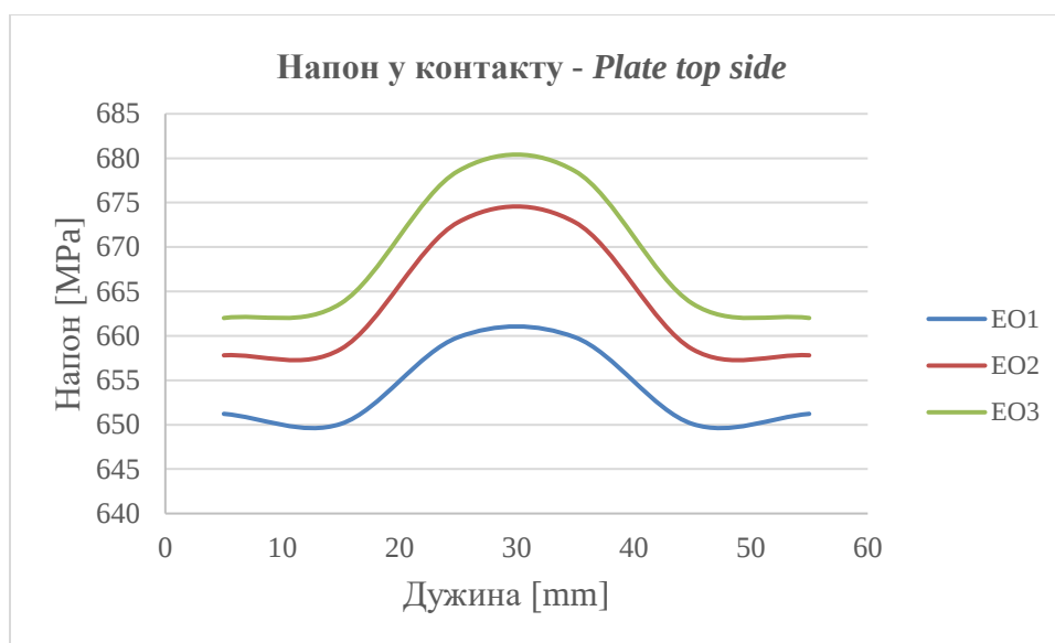
Слика 5.29 Густина мреже 10 mm x 20 mm - Промена напона у контактном региону у зависности од ЕО
