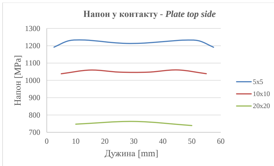
Слика 8.25 Промена напона у контактном региону у зависности од густине мреже
