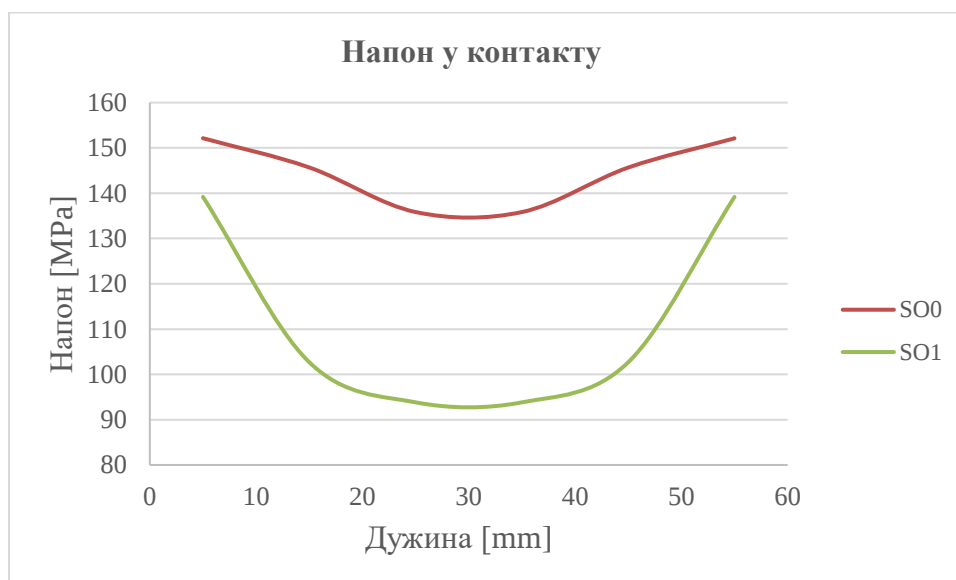
Слика 8.49 Густина мреже 10 mm x 5 mm - Промена напона у контактном региону у зависности од SO
