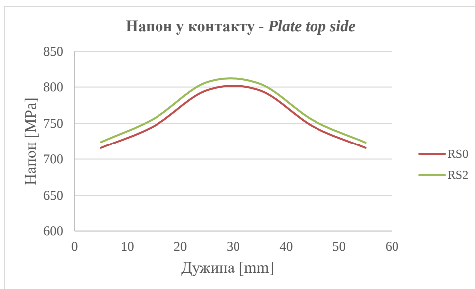
Слика 6.35 Густина мреже 10 mm x 5 mm - Промена напона у контактном региону у зависности од RS
