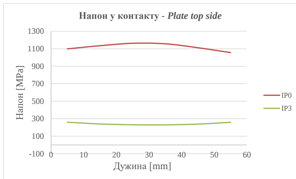
Слика 6.25 Густина мреже 10 mm x 20 mm - Промена напона у контактном региону у зависности од IP
