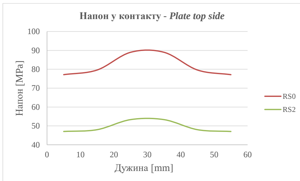
Слика 7.42 Густина мреже 10 mm x 10 mm - Промена напона у контактном региону у зависности од RS
