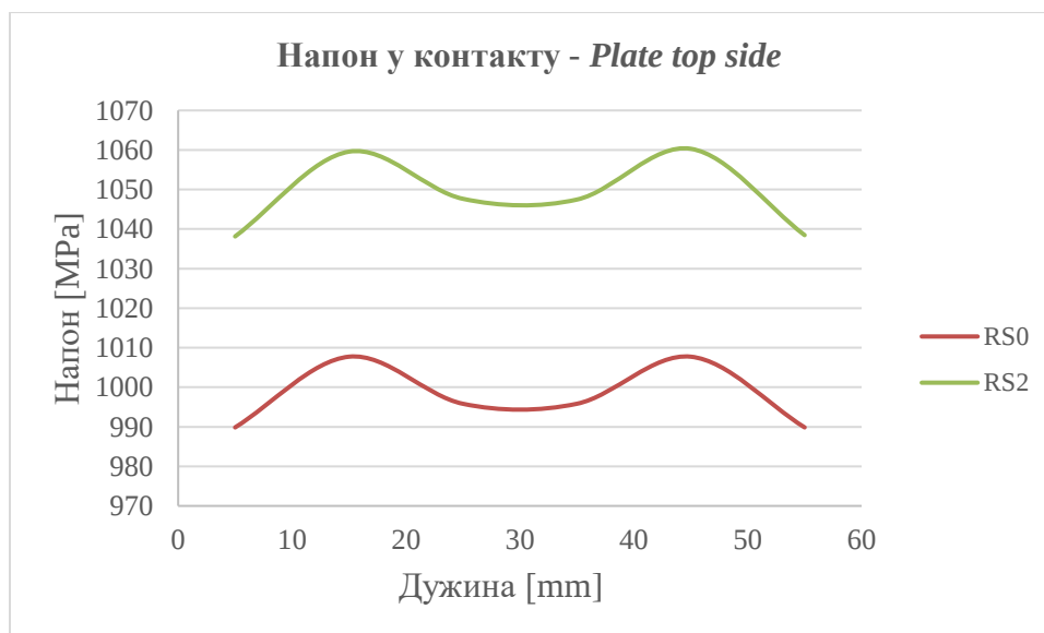
Слика 8.31 Густина мреже 10 mm x 10 mm - Промена напона у контактном региону у зависности од RS
