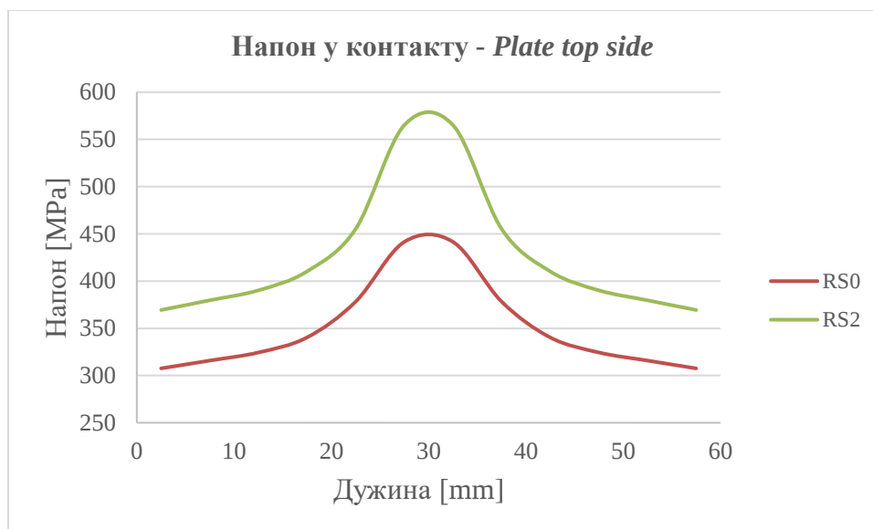
Слика 7.26 Густина мреже 5 mm x 10 mm - Промена напона у контактном региону у зависности од RS
