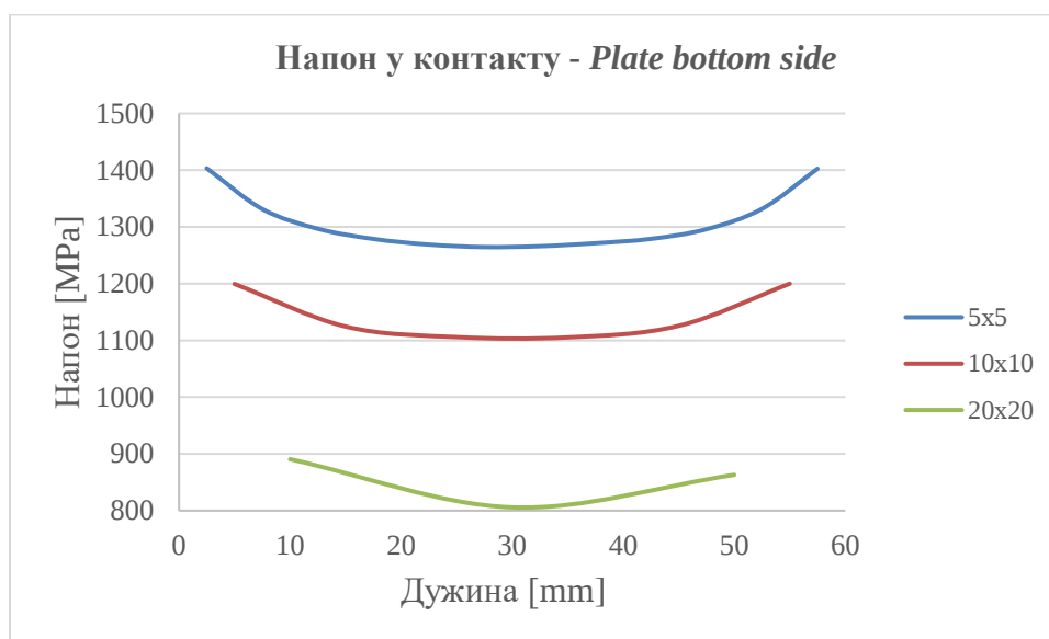
Слика 8.26 Промена напона у контактном региону у зависности од густине мреже
