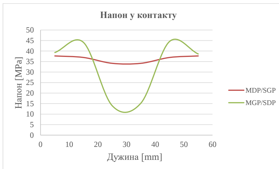
Слика 5.10 Густина мреже 10 mm x 20 mm - Промена напона у контактном региону у зависности од положаја master и slave сегмента, где су: MDP – master доња плоча, SGP – slave горња плоча, MGP – master горња плоча и SDP – slave доња плоча
