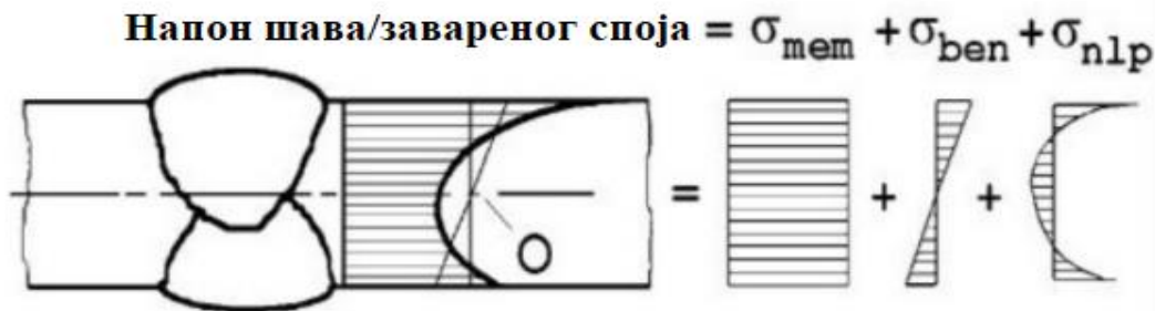
Слика 1. Дистрибуција напона у области завареног споја
