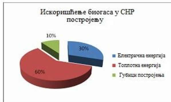
Слика 10: Искоришћење биогаза у СНР постројењу
