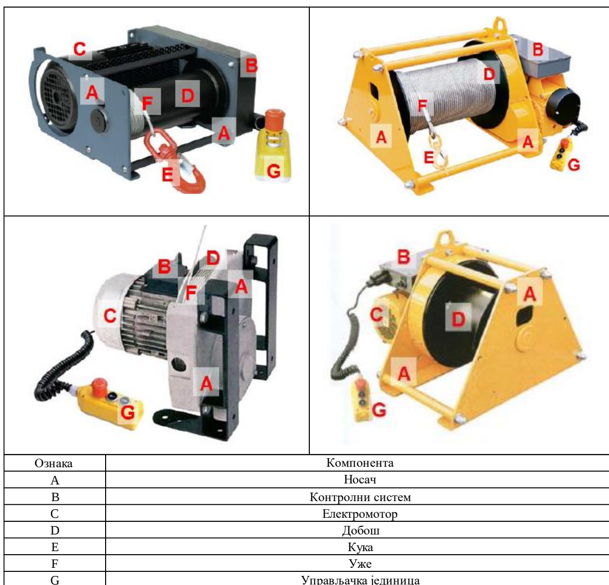
Слика 2.7: Примери витла са електромоторним погоном и њихове компоненте [8]
