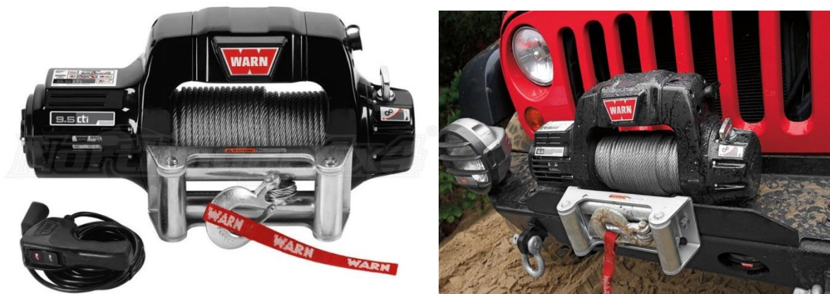
Слика 2.3: Вучно витло за возила Warn 9.5 CTI [5]
