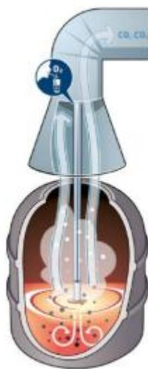
Слика 4.3 Упроишћени приказ LD конвертора
