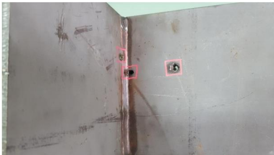
Слика 6.16 Приказ испитаног узорка угаоног споја са излазне стране
