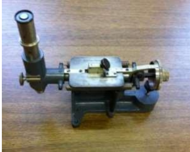
Слика 6.6 Уређај за мерење дужине прслине
