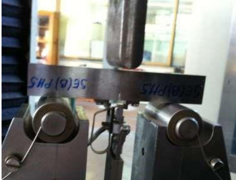
Слика 6.7 Опрема за испитивање механике лома: основи ваљци, екстензометар, SEN(B) епрувета и трн за савијање
