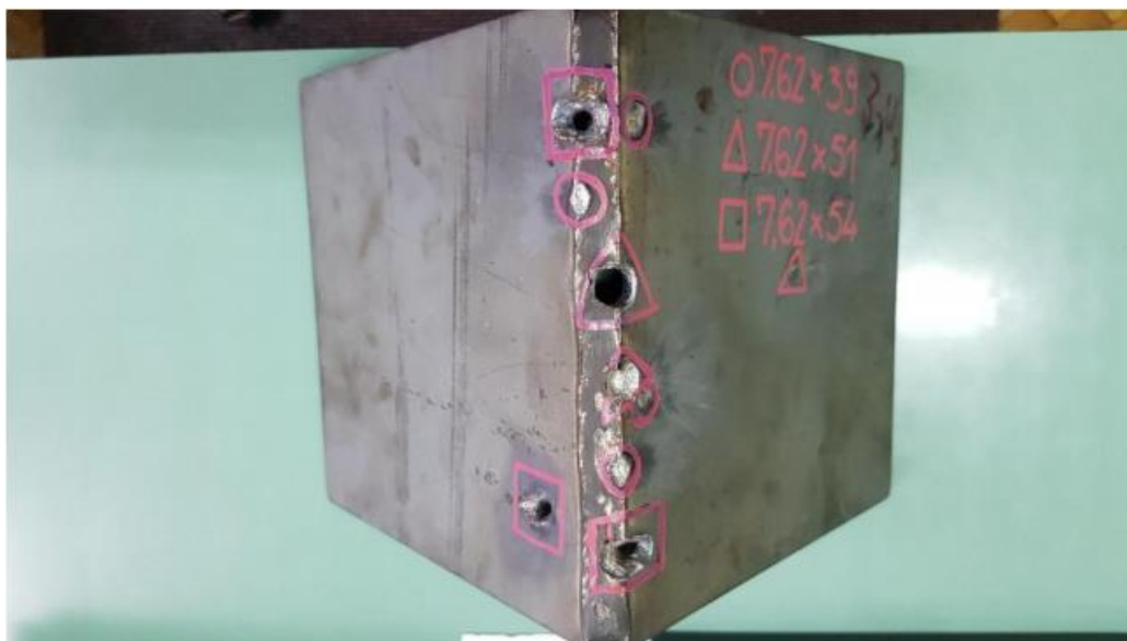
Слика 6.17 Приказ испитаног узорка угаоно-рубног споја са улазне стране
