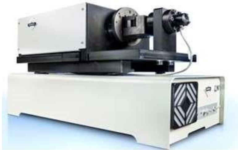
Слика 6.5 Високофреквентни пулзатор за стварање заморне прслине
