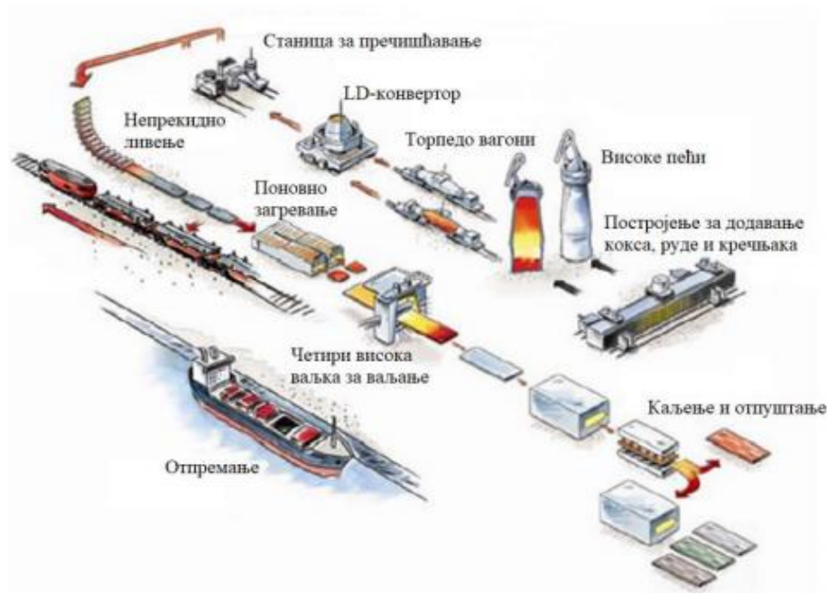
Слика 4.1 Схематски приказ процеса производње челика повишене јачине
