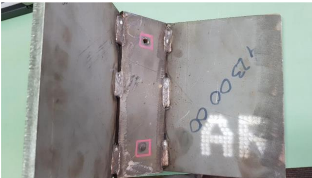
Слика 6.18 Приказ испитаног узорка угаоно-рубног споја са улазне стране
