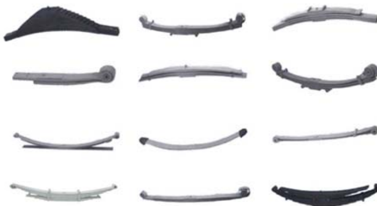
Слика 3. Примери сложених лиснатих опруга
