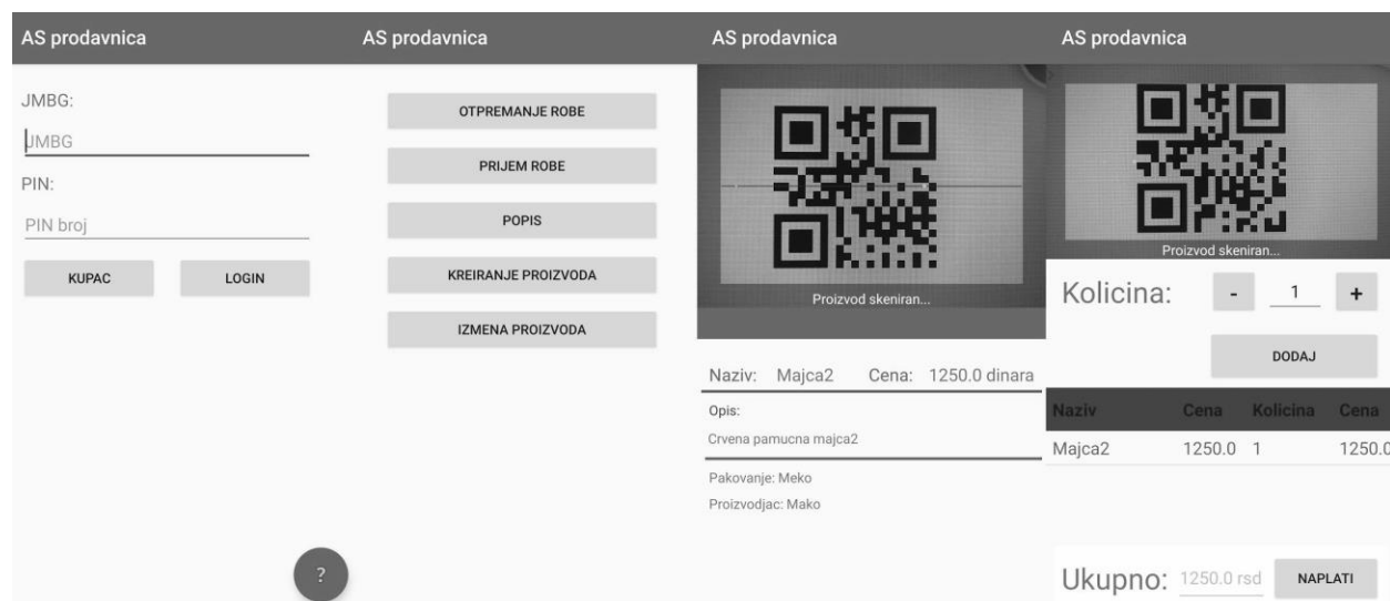
Слика 32. Приказ екрана андроид апликације, а) пријава корисника на систем, б) главни мени запосленог у складишту, в) провера цене, г) издавање рачуна
