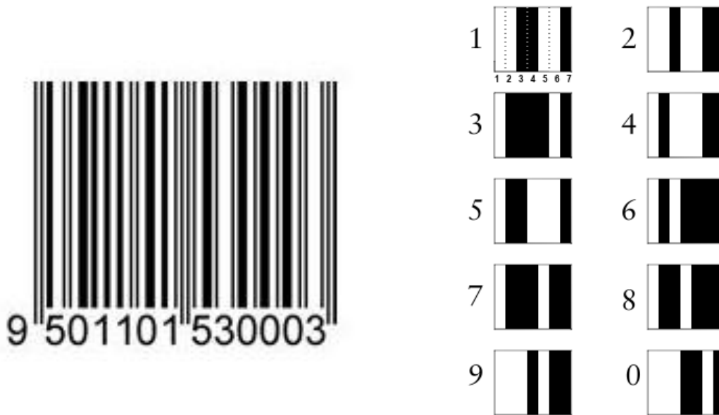
Слика 2. Баркод ( Лерво ), кодовање баркод-а ( десно ) (Barkod, 2009)
