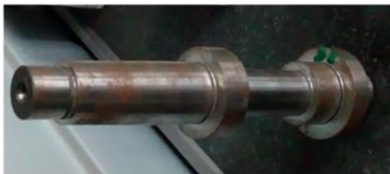
Слика 60. Предмет добијен завршном обрадом обимним брушењем
