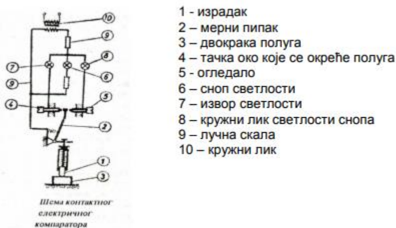
Слика 27. Шема контактеног електричног компаратора
