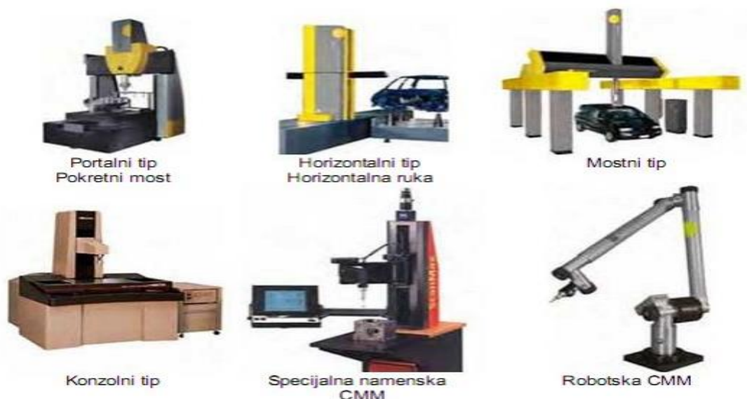
Слика 50. Типови координатних мерних машина
