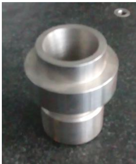
Слика 59. Предмет добијен обрадом стругањем
