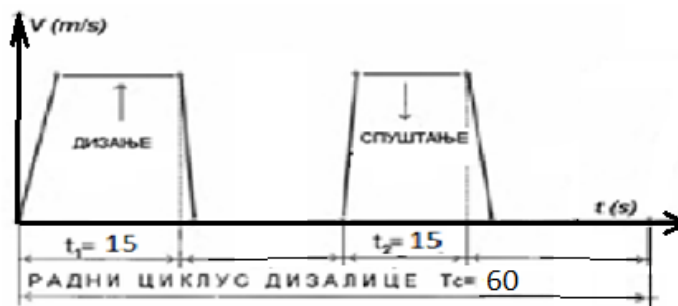
Слика 50. Радни циклус механизма за дизање
