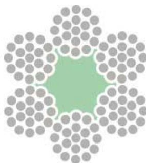
Слика 38. Попречни пресек ужета (1+6+12+18) [7]
