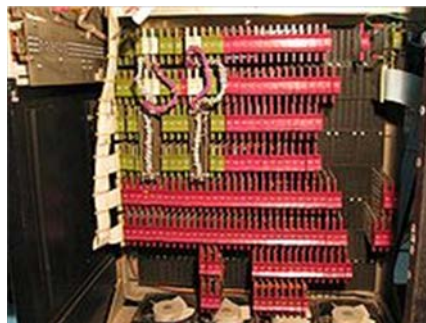
Слика 3. Процесор, меморијско језгро и спољни бус интерфејс на DEC PDP-8/I.
