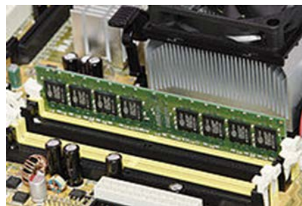
Слика 13. 1GB SDRAM-а монтирана на личном рачунару. Пример примарног складиштења.
