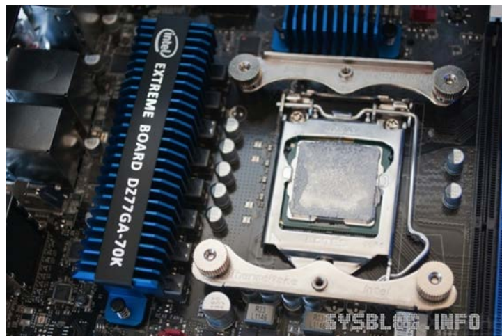
Слика 19. Microprocessor Intel Core i7-3770K: 4 језгра такта 3.5 GHz, до 3.9 GHz у турбо моду
