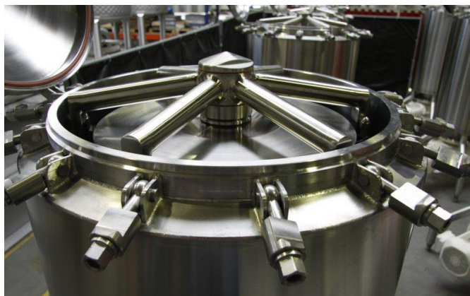
Слика:5.4.-Kelstream размењивач топлоте са мешалицом.[16]
